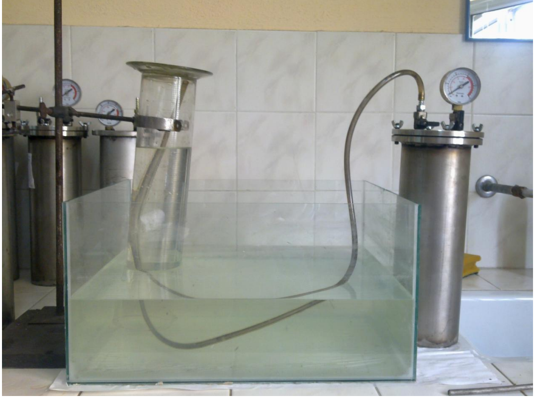
Şekil 7.5 : Gaz içeriğinin ölçülmesinde kullanılan deney düzeneği.
