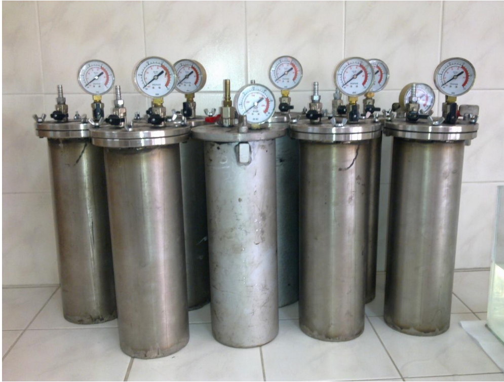
Şekil 7.4 : Kömür damarından alınan numunelerin konulduğu sızdırmaz kaplar.
