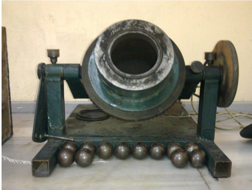
Şekil 7.7 : Sızdırmaz değirmen ve bilyaların görünümü.
