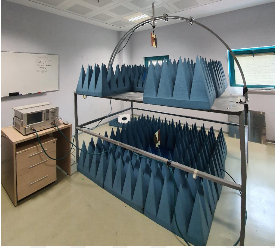
Şekil 5.60 : ATAM labaratuvar ölçüm düzeneği.
