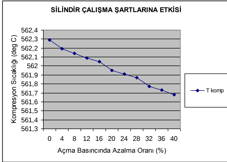
Şekil I.3 Enjektör nozul açma basıncındaki azalmaların etkileri
