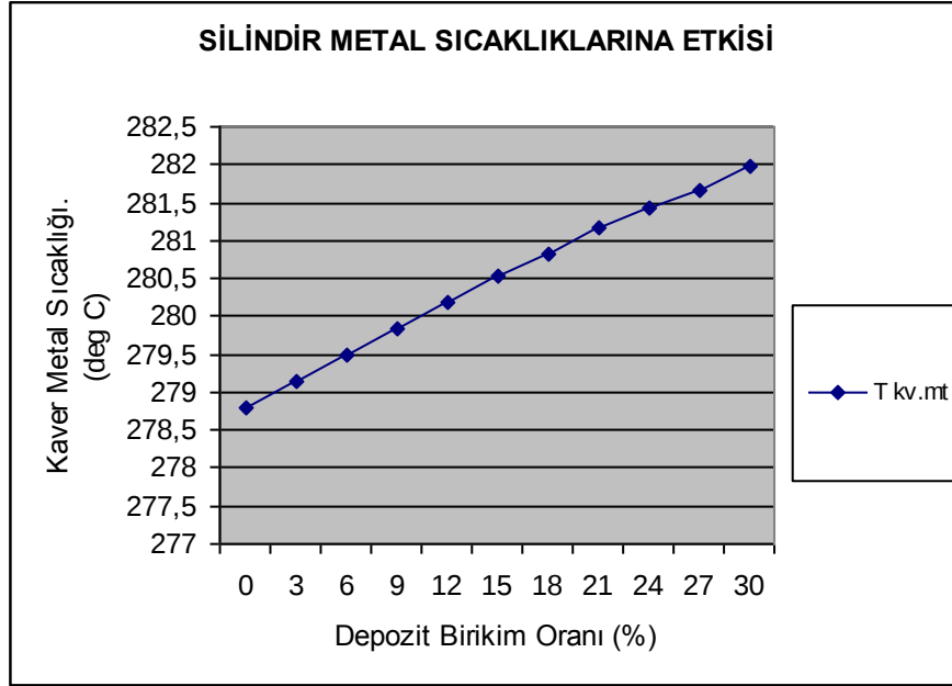
Şekil F.7 Piston tacında depozit birikiminin etkileri
