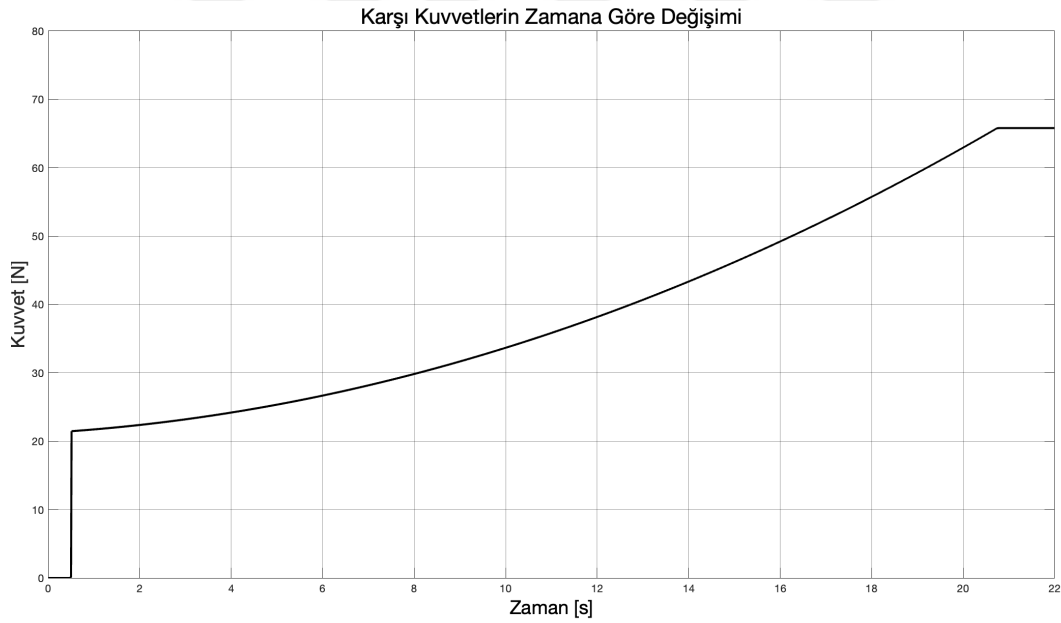
Şekil 3.11 : Karşı kuvvetlerin artan hıza göre değişimi.
