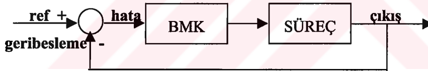
Şekil 3.1 Geribeslemeli bir BMK sistemi blok şeması
