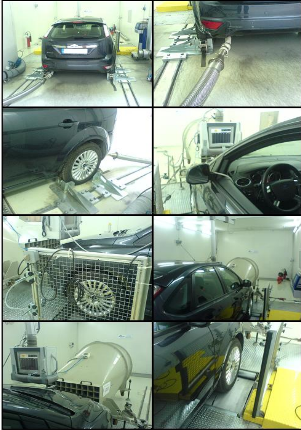
Şekil 4.15 : Deney aracının test düzeneği ile bağlantısı.
