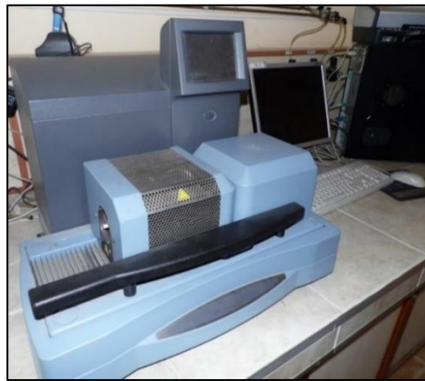
Şekil 3.8 : TA™ Instruments SDT Q 600 Diferansiyel Termal Analiz Cihazı.
