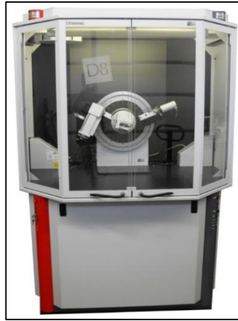
Şekil 3.5 : Bruker™ D8 Advance X-Işınları Difraktometresi.
