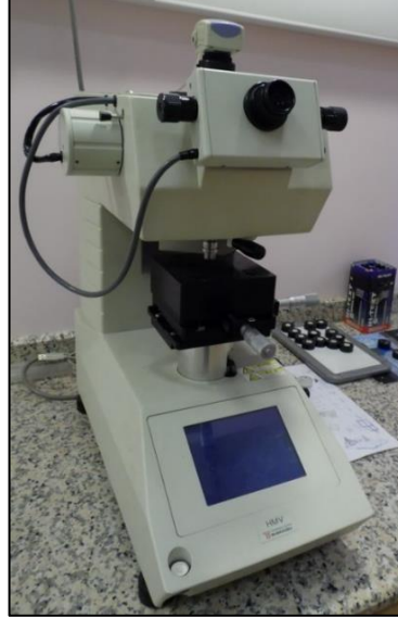
Şekil 3.16 : Shimadzu™ HV2 Mikrosertlik Cihazı.
