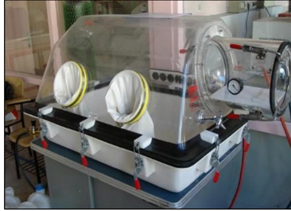
Şekil 3.3 : Plaslabs TM Kapalı Ortam Kutusu (Glove Box).
