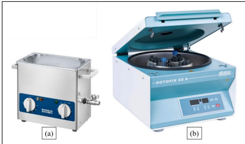
Şekil 3.4 : (a) Bandelin TM Sonorex Ultrasonik Banyo, (b) Hettich ROTOFIX 32 A Santrifüj Cihazı.
