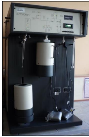
Şekil 3.7 : Quantachrome™ Autosorb Yüzey Alanı ve Porozite Ölçüm Cihazı.
