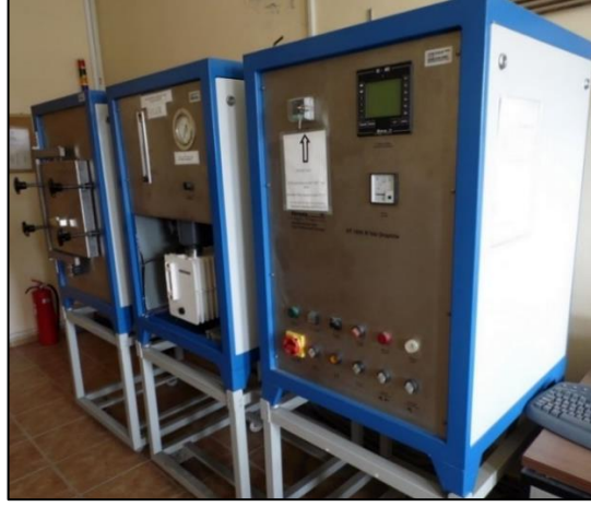
Şekil 3.12 : Linn TM 1800 M Vac Atmosfer Kontrollü Sinter Fırını.
