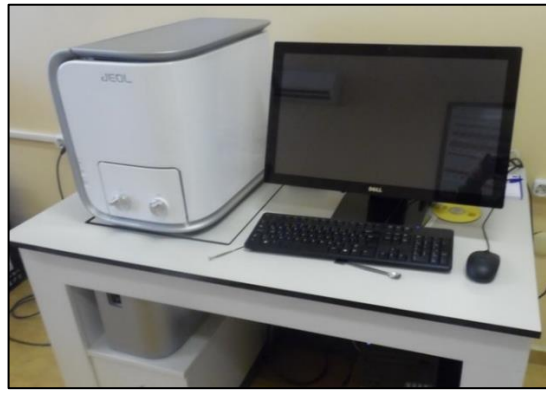
Şekil 3.9 : JEOL TM JCM-6000Plus Neoscope Taramalı Elektron Mikroskobu.
