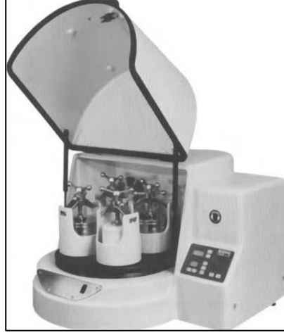
Şekil 2.7 : 4 konumlu Fritsch Pulverizatör 5 gezegen tipi değirmen.
