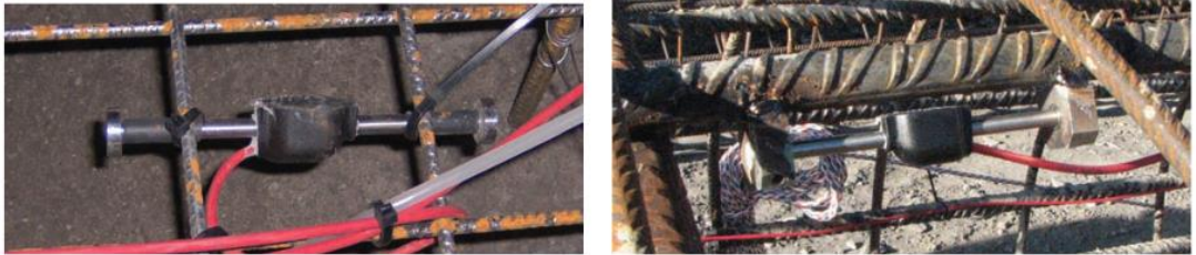
Şekil 4.3 : Donatı kafesine kaynaklanmış bir deformasyon ölçer.
