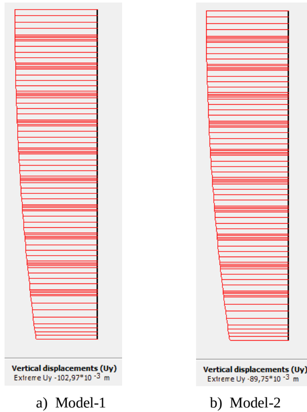
Şekil 7.15 : İki modelde nihayi kazı kotunda perdede oluşan düşey deplasmanlar.
