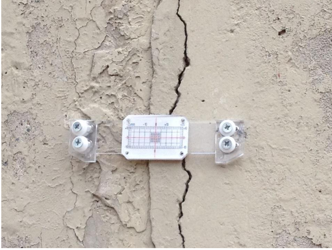
Şekil 4.1 : Çatlak ölçer (crackmeter) [23].
