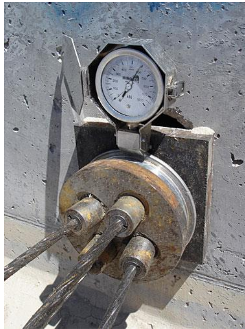
řekil 4.4 : Zemin ankrajına yerleřtirilmiř bir yk hcresi [23].
