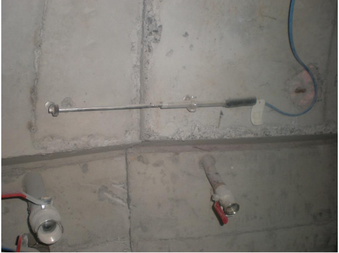
Şekil 4.2 : Eklem ölçer (jointmeter) [23].
