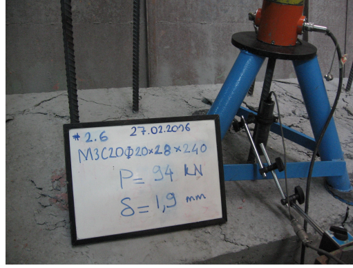
Şekil 5.162 M3C20 \Phi 20x28x240 Ankraj No:2.6
