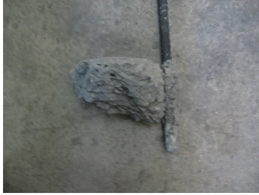
Şekil 5.56 M1C20Φ20x26x200-H Ankrajına Ait Çekme Konisi
