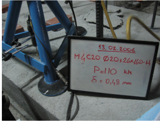
Şekil 5.204 M4C20Φ20x26x160-H Ankraj No:6.14
