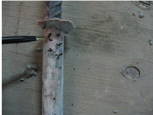
Şekil 5.182 M3C20 \Phi 20x26x160-D Ankrajına Ait Çekme Konisi
