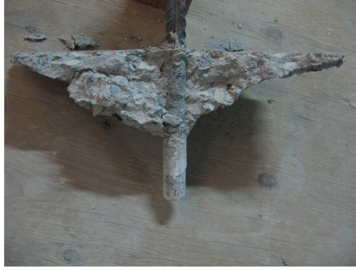
Şekil 5.100 M2C20 \Phi 20x26x160 Ankrajına Ait Çekme Konisi
