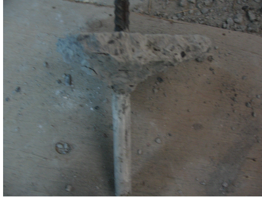
Şekil 5.106 M2C20 \Phi 20x26x240 Ankrajına Ait Çekme Konisi
