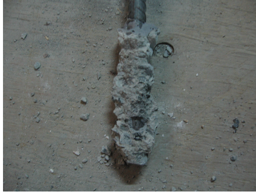
Şekil 5.194 M4C20 \Phi 20x26x160 Ankrajına Ait Çekme Konisi
