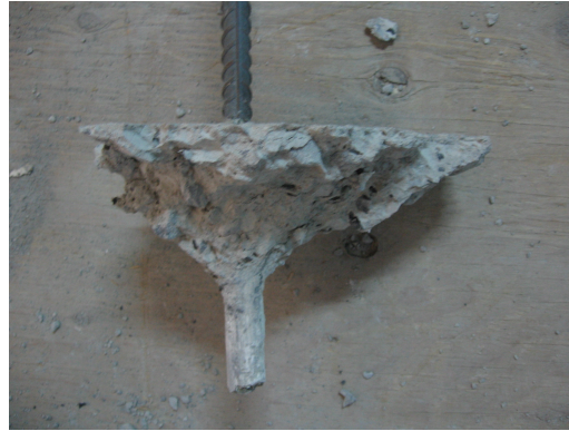
Şekil 5.80 M2C20Φ16x22x160 Ankrajına Ait Çekme Konisi
