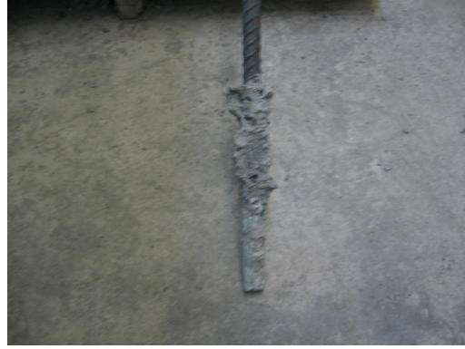
Şekil 5.59 M1C20 \Phi 20x26x240-H Ankrajına Ait Çekme Konisi
