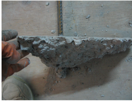
Şekil 5.21 M1C20 \Phi 16x24x160 Ankrajına Ait Çekme Konisi
