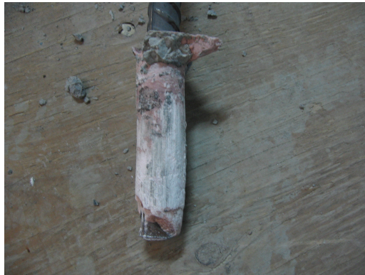
Şekil 5.155 M3C20 \Phi 20x28x120 Ankrajına Ait Çekme Konisi
