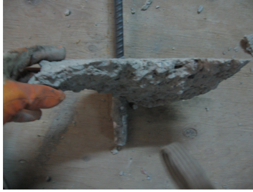
Şekil 5.218 M4C20Φ20x26x160-D Ankrajına Ait Çekme Konisi
