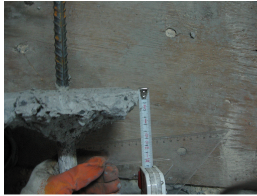
Şekil 5.77 M2C20 \Phi 16x22x128 Ankrajına Ait Çekme Konisi
