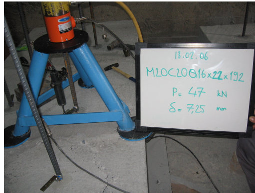
Şekil 5.81 M2C20Φ16x22x192 Ankraj No:5.3
