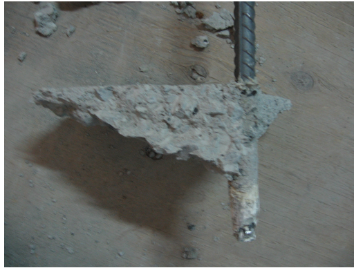
Şekil 5.111 M2C20Φ20x28x160 Ankrajına Ait Çekme Konisi
