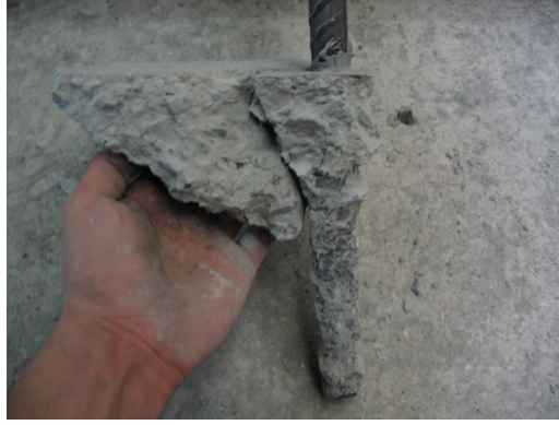
Şekil 5.197 M4C20 \Phi 20x26x200 Ankrajına Ait Çekme Konisi
