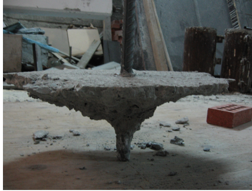
Şekil 5.29 M1C20 \Phi 20x26x160 Ankrajına Ait Çekme Konisi
