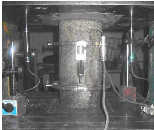
Şekil 3.1 Standart Silindir Basınç Deneyi Düzenegi
