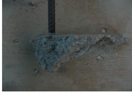
Şekil 5.38 M1C20 \Phi 20x28x120 Ankrajına Ait Çekme Konisi
