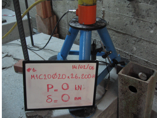
Şekil 5.54 M1C20 \Phi 20x26x200-H Ankraj No:6.1
