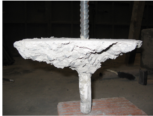
Şekil 5.114 M2C20 \Phi 20x28x200 Ankrajına Ait Çekme Konisi
