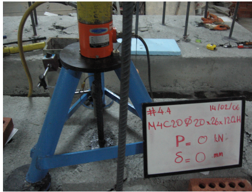
Şekil 5.201 M4C20 \Phi 20x26x120-H Ankraj No:4.4
