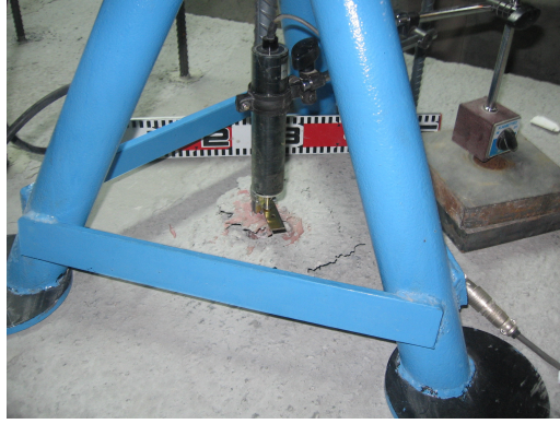
Şekil 5.147 M3C20 \Phi 20x26x200 Ankraj No:5.9
