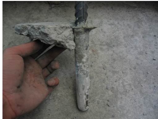
Şekil 5.123 M2C20Φ20x26x160-H Ankrajına Ait Çekme Konisi
