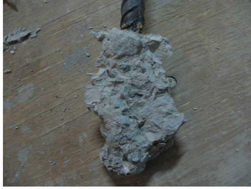
Şekil 5.227 M5C20Φ20x30x120 Ankrajına Ait Çekme Konisi
