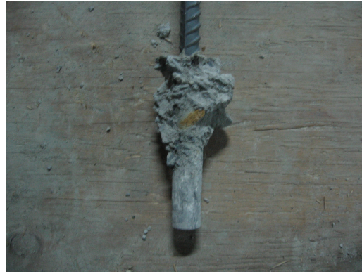
Şekil 5.89 M2C20Φ16x24x128 Ankrajına Ait Çekme Konisi
