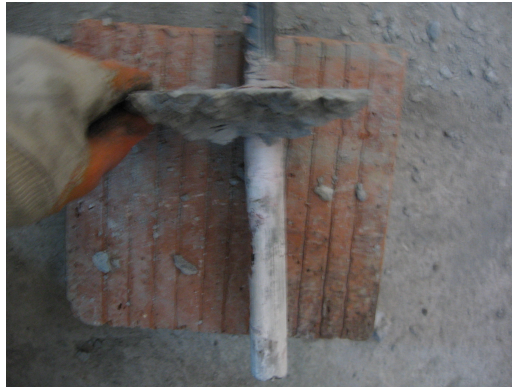
Şekil 5.149 M3C20 \Phi 20x26x200 Ankrajına Ait Çekme Konisi
