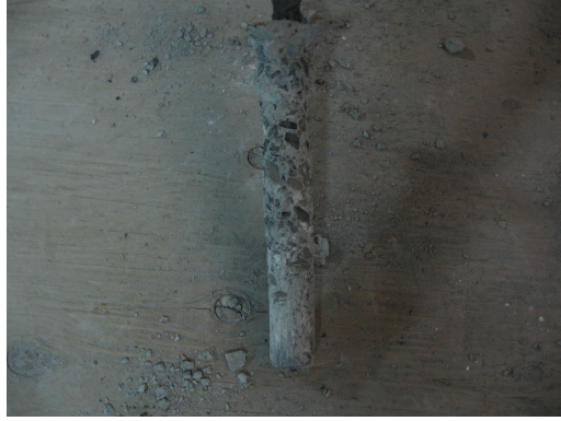
Şekil 5.236 M5C20 \Phi 20x30x240 Ankrajına Ait Çekme Konisi
