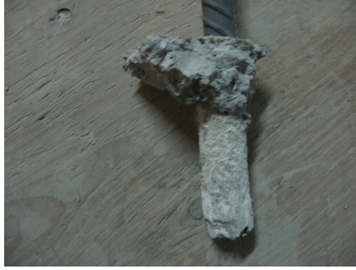
Şekil 5.109 M2C20Φ20x28x120 Ankrajına Ait Çekme Konisi
