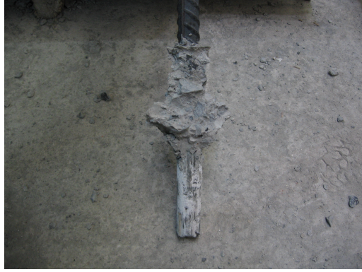
Şekil 5.68 M1C20Φ20x26x200-D Ankrajına Ait Çekme Konisi
