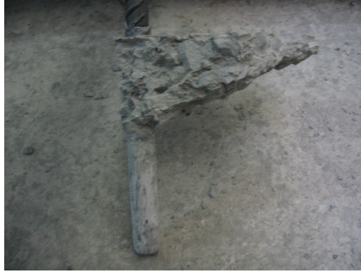
Şekil 5.209 M4C20Φ20x26x200-H Ankrajına Ait Çekme Konisi
