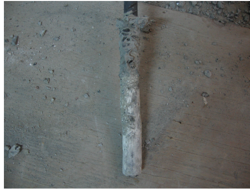
Şekil 5.117 M2C20 \Phi 20x28x240 Ankrajına Ait Çekme Konisi
