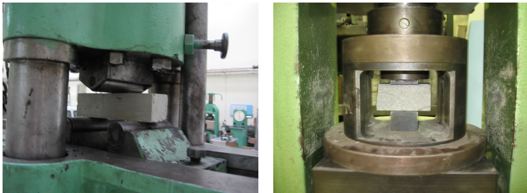
Şekil 3.5 M1 Malzemesine Ait Eğilme ve Basınç Testleri
