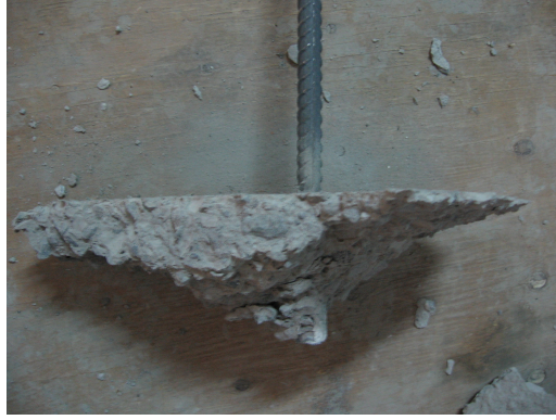
Şekil 5.62 M1C20 \Phi 20x26x120-D Ankrajına Ait Çekme Konisi
