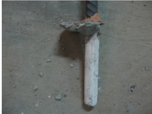
Şekil 5.146 M3C20Φ20x26x160 Ankrajına Ait Çekme Konisi
