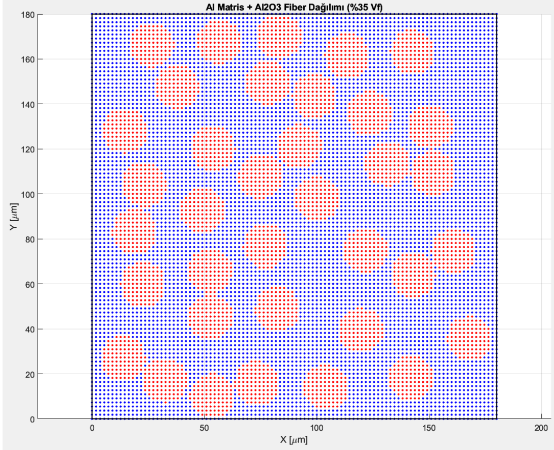
Şekil 3.4 : Al matris / \text{Al}_2\text{O}_3 fiber %35 hacim oranlı RVE modeli
