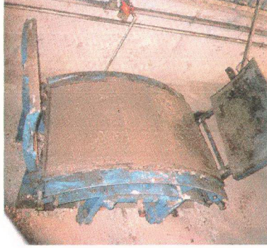
Şekil 9.3 Çıkan havanın oluşturduğu pürüzlü segment yüzeyi
