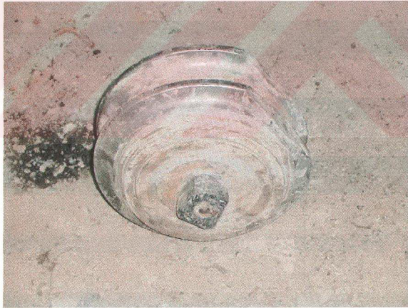
Şekil 12.4 Yatağı bloke olmuş ve aşınmış bir disk keski
