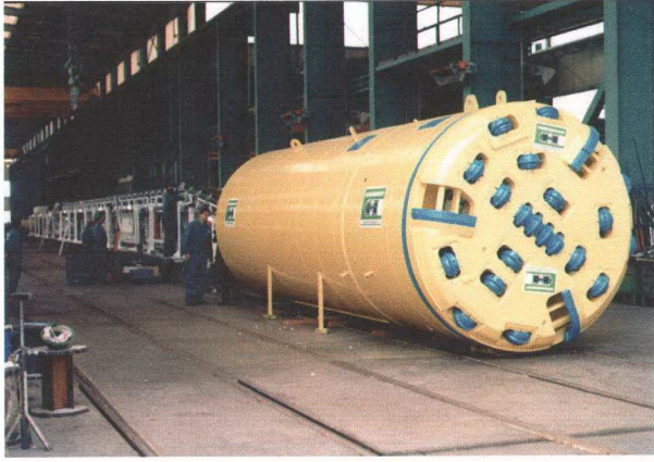
Şekil 6.2 Tarabya atık su tüneline kullanılan tünel açma makinesi
