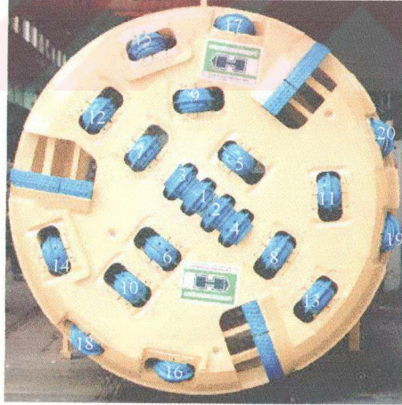
Şekil 12.1 Tarabya Atık Su tüneline kullanılan TBM'in Kesici Kafası
