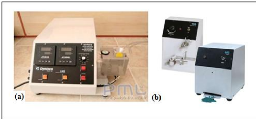
Şekil 3.3 : Ekstrüder cihazı ve aksesuarlar. (a) Laboratuvar Tipi Ekstrüder Dynisco TM LME 230. (b) Dynisco TM LEC 230 Model Granülatör ve TUS 230.
