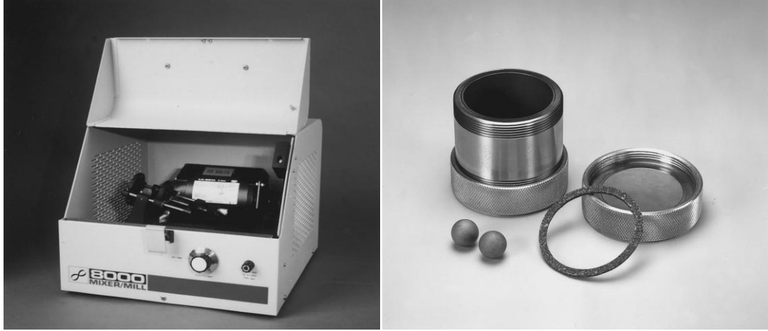
Şekil 2.7 : Spex™ 8000 karıştırıcı/öğütücü ve WC kap ve bilyeler (Suryaranayana, 2001).
