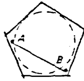
Şekil 4.25.a. Konveks mekân: mekân içindeki herhangi iki nokta arasında çizilmiş olan hiçbir çizgi mekân dışına çıkmamaktadır.
