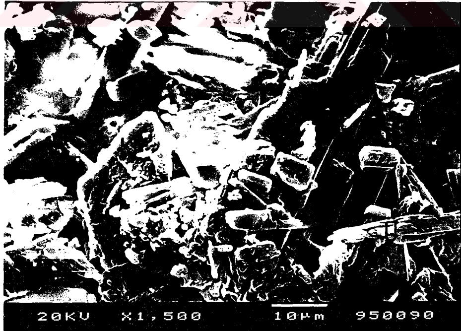
Şekil 4.43. Üleksit+Kil Sisteminin SDS ile \text{BaCl}_2 varlığında SEM'de Görünümü ( 2 \times 10^{-4} M SDS) Ü : Üleksit K : Kil
