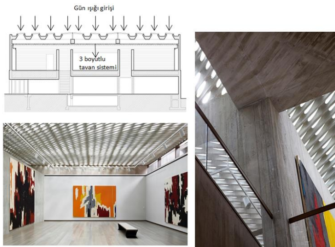
Şekil 4.21 : Tavan sistem kesiti ve mekan içinden görsel (Url-19).
