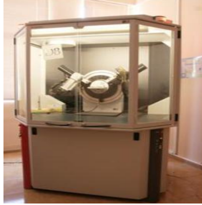
Şekil 3.15: Bruker marka X-ışını Difraktometresi.
