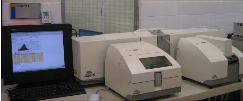
Şekil 3.13: Malvern marka partikül boyut ölçüm cihazı.
