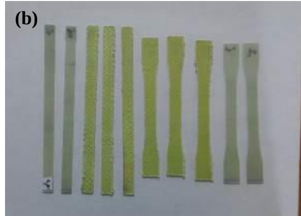
Şekil 1. Modal analiz test düzeneği. (a) Düzeneğin genel görünümü, (b) Test numuneleri
