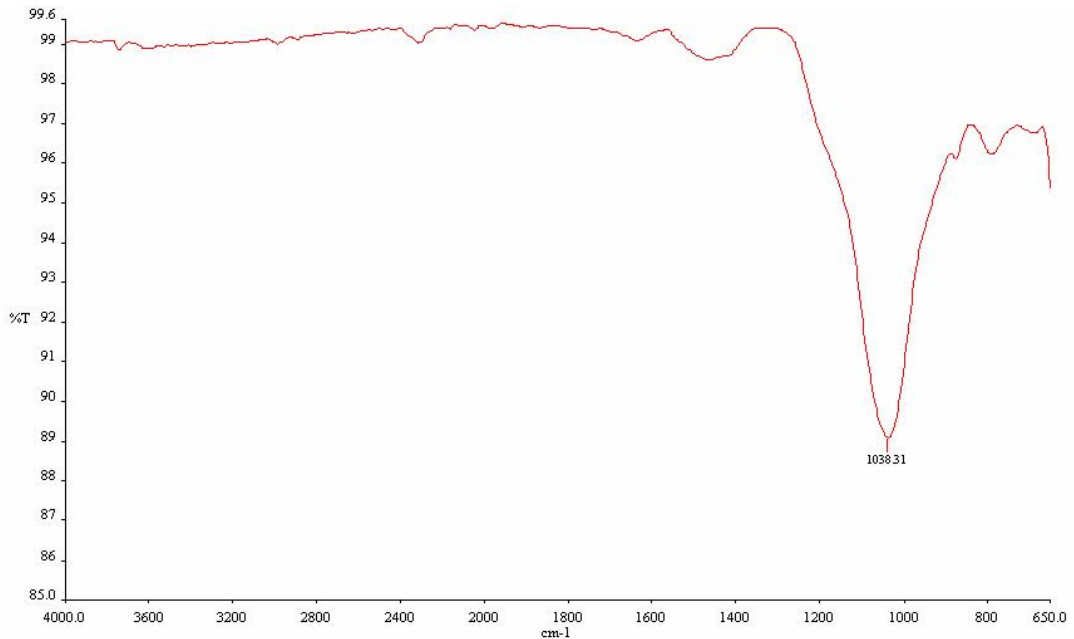
Şekil 6.12: 58S biyoaktif cam numunesinin SBF öncesi FTIR grafiği
