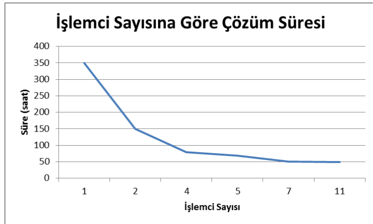
Şekil 3.2 : Fluent yazılımında aynı problemin paralel işlemci sayısına göre çözüm performansı.
