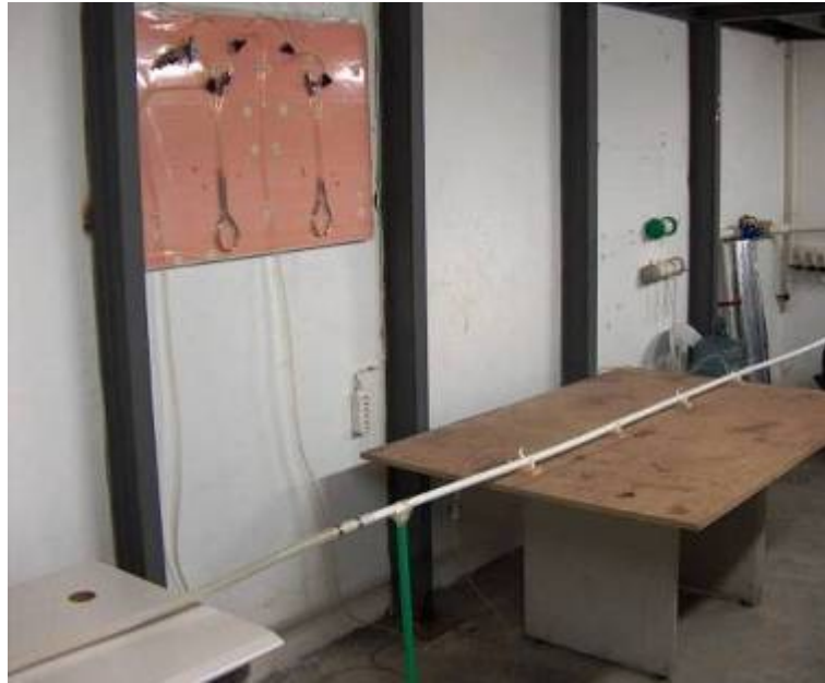
Şekil 3.31 Deneyde su debisini ölçme sistemi
