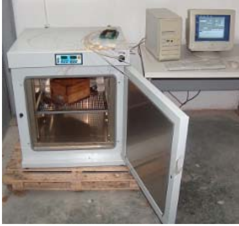
Şekil 3.29 Ahşap kabın fırın içine yerleştirilmesi
