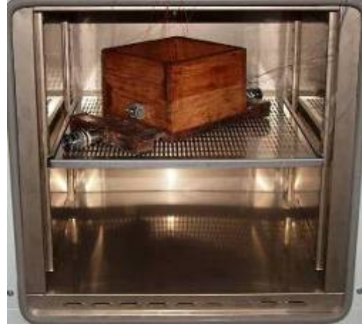
Şekil 3.29 Ahşap kabın fırın içine yerleştirilmesi
