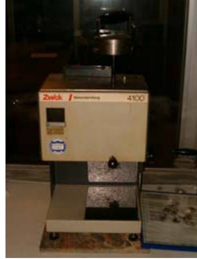
Şekil 3.23 Eriyik akış indisi cihazı ile MFI değerinin bulunması
