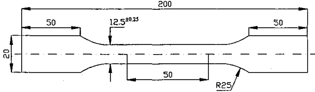
Şekil 4.4 Çekme deneyi numunesi boyutları [105]
