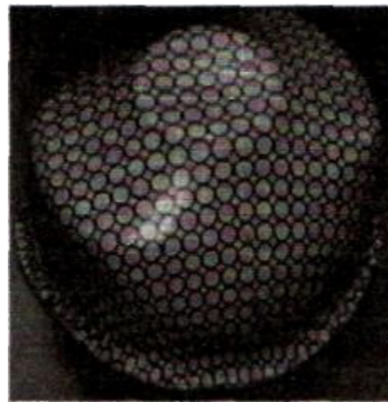
Şekil 2.52 Serigrafi yöntemiyle yüzeyi daire desenleri işlenmiş sac malzeme (işlenen daireler 5mm çapında) [69].
