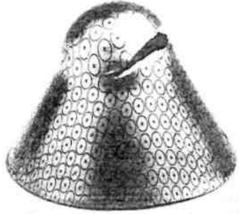
Şekil 2.33 Hasarlı Fukui kap [51]
