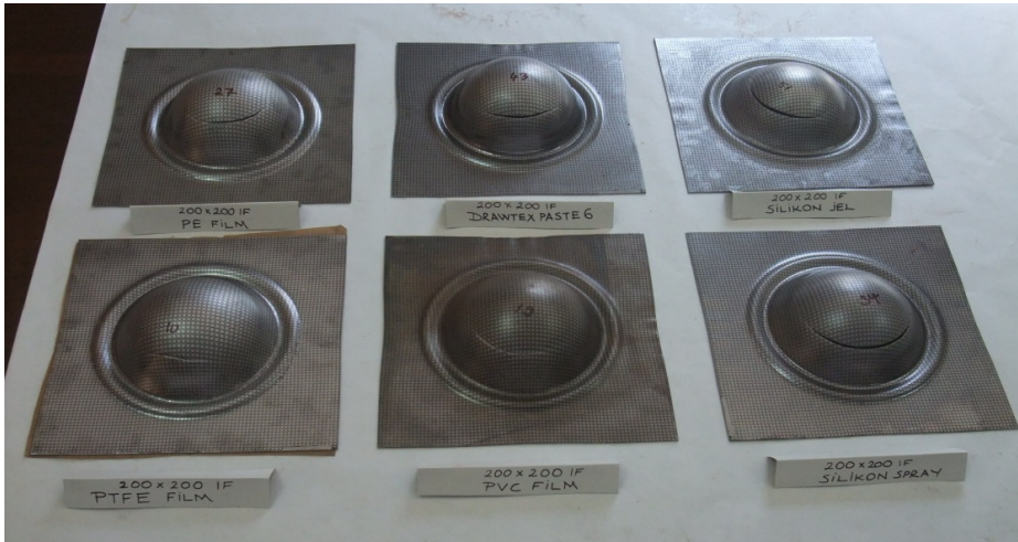
Şekil 4.26 Farklı yağlayıcılarla deforme edilmiş 200 x 200 IF (ERD 7114) deney numuneleri
