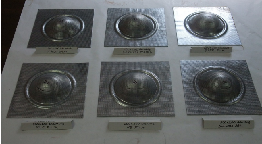
Şekil 4.25 Farklı yağlayıcılarla deforme edilmiş 200 x 200 galvanizli (ERD 1313) deney numuneleri
