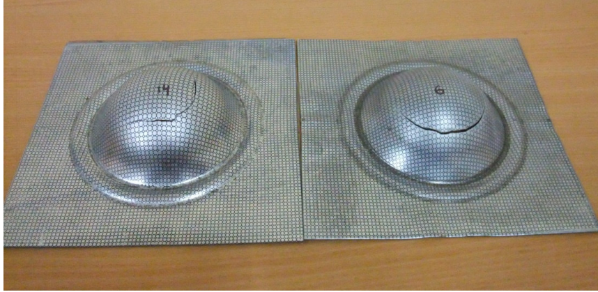
Şekil 6.5 Kuru ve teflon film ile yağlanmış numunelerde gerçekleşen yırtık konumlarının karşılaştırılması (soldaki: Teflon film ile yağlanmış, sağdaki: kuru)
