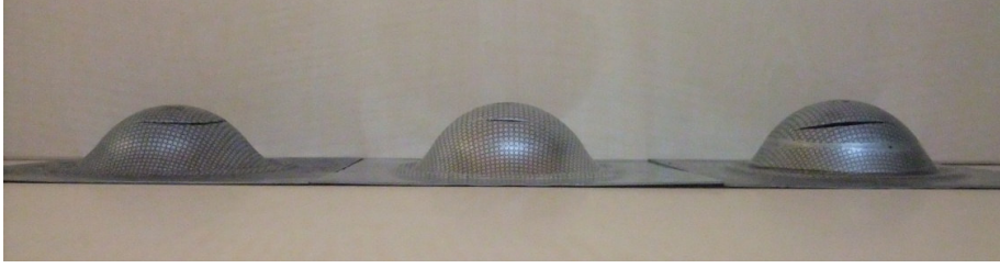
Şekil 6.3 Farklı yağlayıcılarla çökertilen ERD 1313 galvanizli deney numuneleri (soldan sağa sırasıyla silikon jel, PVC ve mineral yağ)
