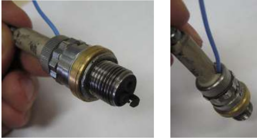
Şekil 3.8 Basınç sensörünün yerleştirilmesi için üretilen buji adaptörü
