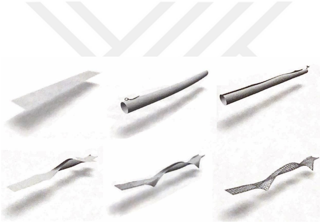
Şekil 2.13: Düzlemsel ve silindir geometri tipleri arasında dönüşüm olanaklarını değerlendiren bir köprü tasarımı (Reiser, 2006).
