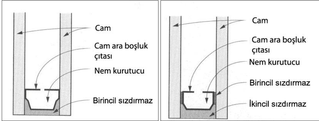
Şekil 2.6: Tek sızdırmazlı cam ünitesi
