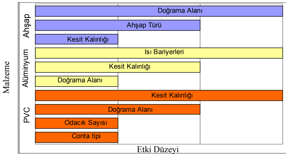
Şekil 6.1: Doğrama özelliklerinin U-değerine etki ediş düzeyi
