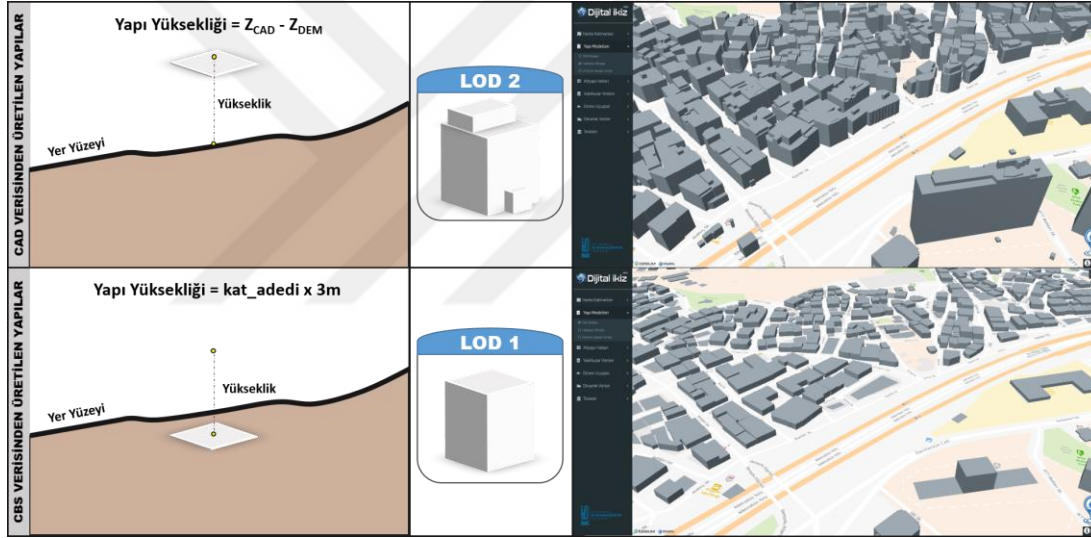
Şekil 3.13 : Dijital İkiz içerisinde CBS ve CAD verilerinden üretilen İSKİ yapı modellerinin görüntülenmesi.
