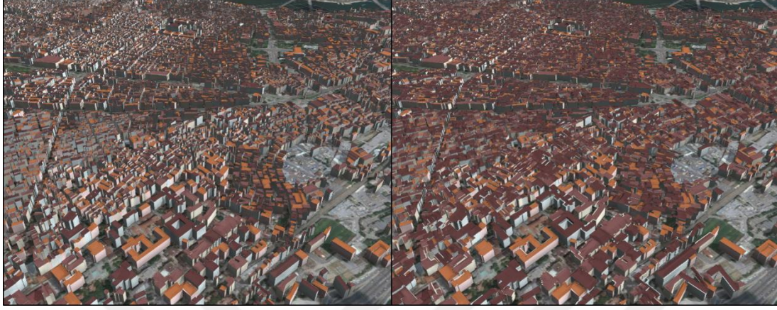
Şekil 3.9 : Temel LOD2 seviyesinde prosedürel modelleme (sol), çatı ve cephe detayları içeren İleri Seviye LOD2 prosedürel modelleme (sağ).
