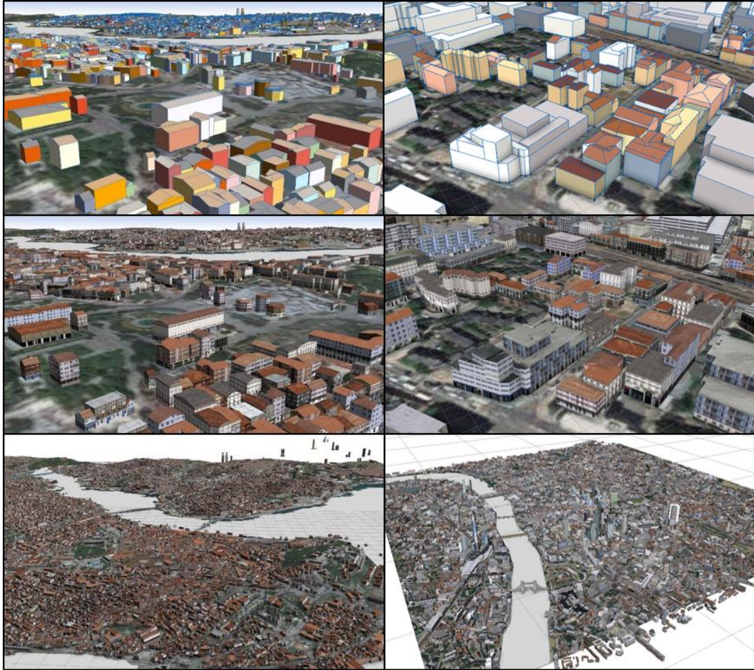
Şekil 3.3 : LOD2 bina modelleri; İstanbul (sol üst), Londra (sağ üst), Rastgele cephe kaplamalı LOD2 bina modelleri; İstanbul (sol orta), Londra (sağ orta), 3B kent modeli tasarımı; İstanbul (sol alt), Londra (sağ alt).
