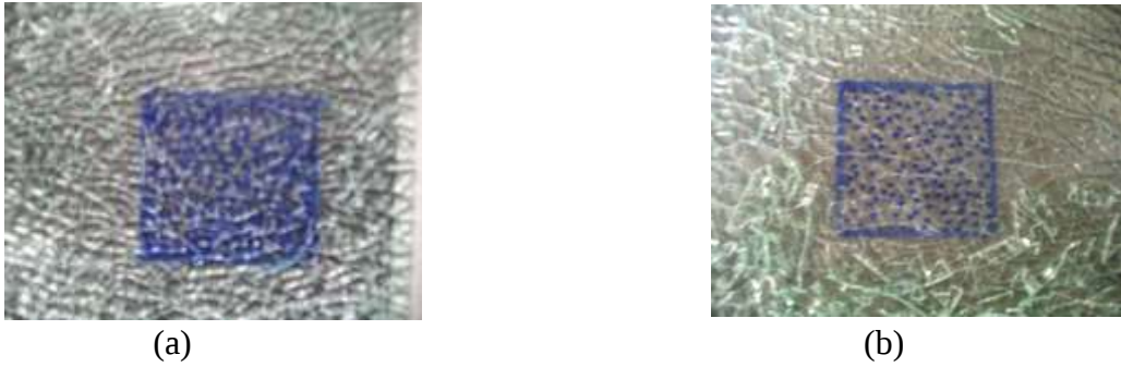
Şekil 4.3 5 cm x 5 cm alan içinde kalan kırık parçaların gösterilişi (a) 4,0 mm için (b) 3,2 mm için
