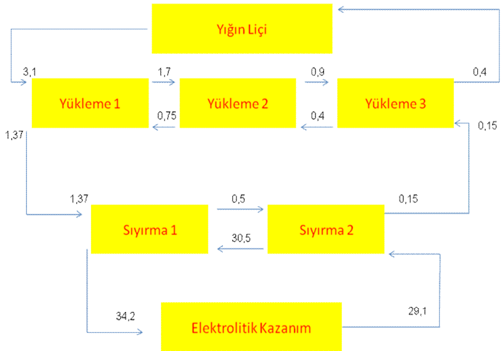
Şekil 3.5 : Bluebird firması tarafından bakır üretiminde kullanılan iş-akış diyagramı.
