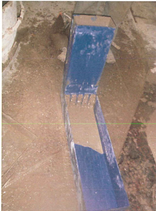
Şekil 3.2: L-kutusu deneyi sırasında liflerden dolayı donatılar arasında tıkanma oluşması
