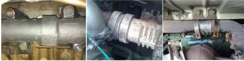
Şekil 6.9: Çok parçalı egzoz manifoldlarında farklı bağlantı stratejileri.
