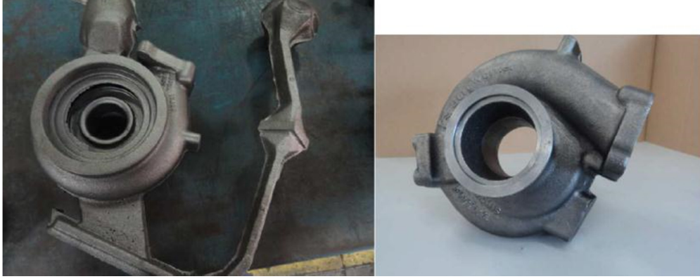
Şekil 7.50: Türbin muhafaza ham döküm ve nihayi hali.
