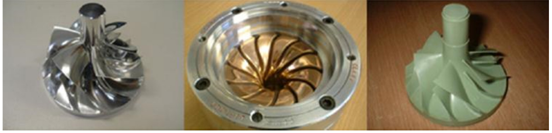
Şekil 7.33: Gips kalıba dökümde ana modeli, ana kalıp ve kauçuk model [21].
