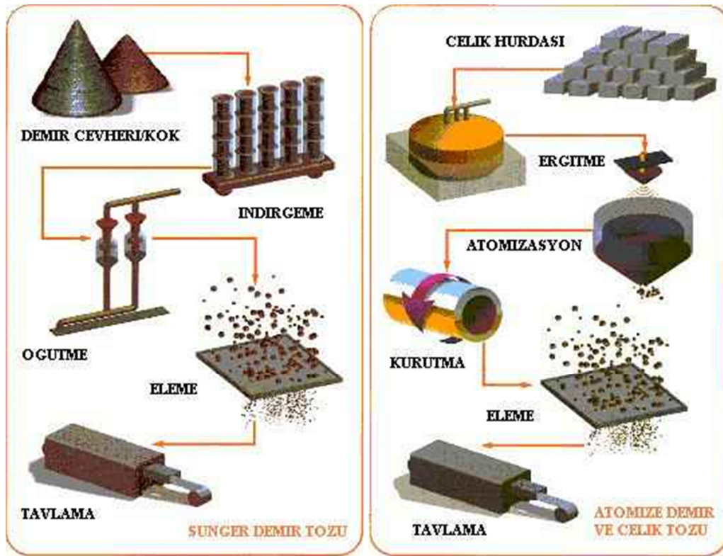
Şekil 7.42: Toz metalin elde ediliş yöntemleri [32].
