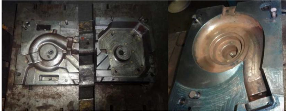
Şekil 7.49: Türbin muhafaza dış kabuk modeli ve iç maça kalıbı.
