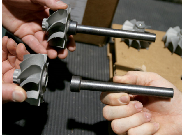
Şekil 7.27: Türbin çarkı ve şaftın kaynama bölgesi [24].
