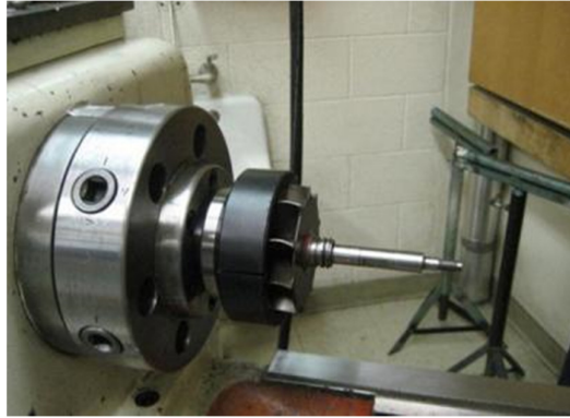
Şekil 7.28: Türbin çarkı ve şaftın kaynak makinesindeki son hali [24].
