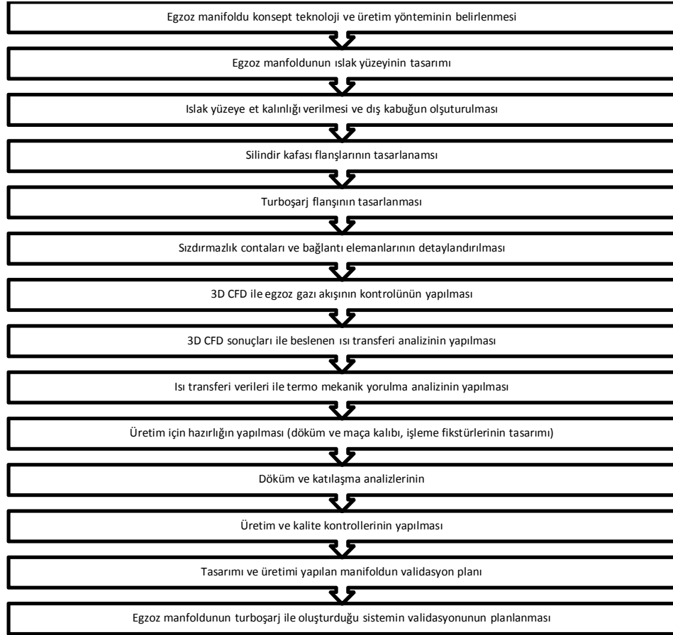
Şekil 8.1: Egzoz manifoldu tasarım ve üretim safhaları.
