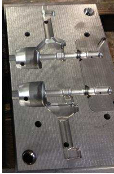
Şekil 7.47: Yatak muhafaza maça modeli.
