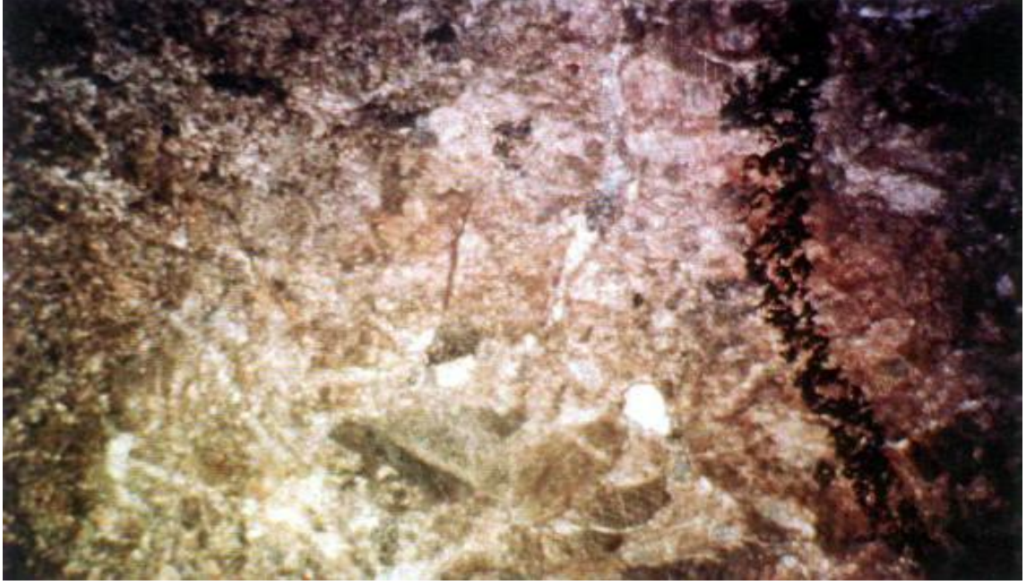
Şekil 5.12 Dolomitik karakter gösteren kireçtaşı örneği. (PI, Büyütme: 2.5*12.5)
