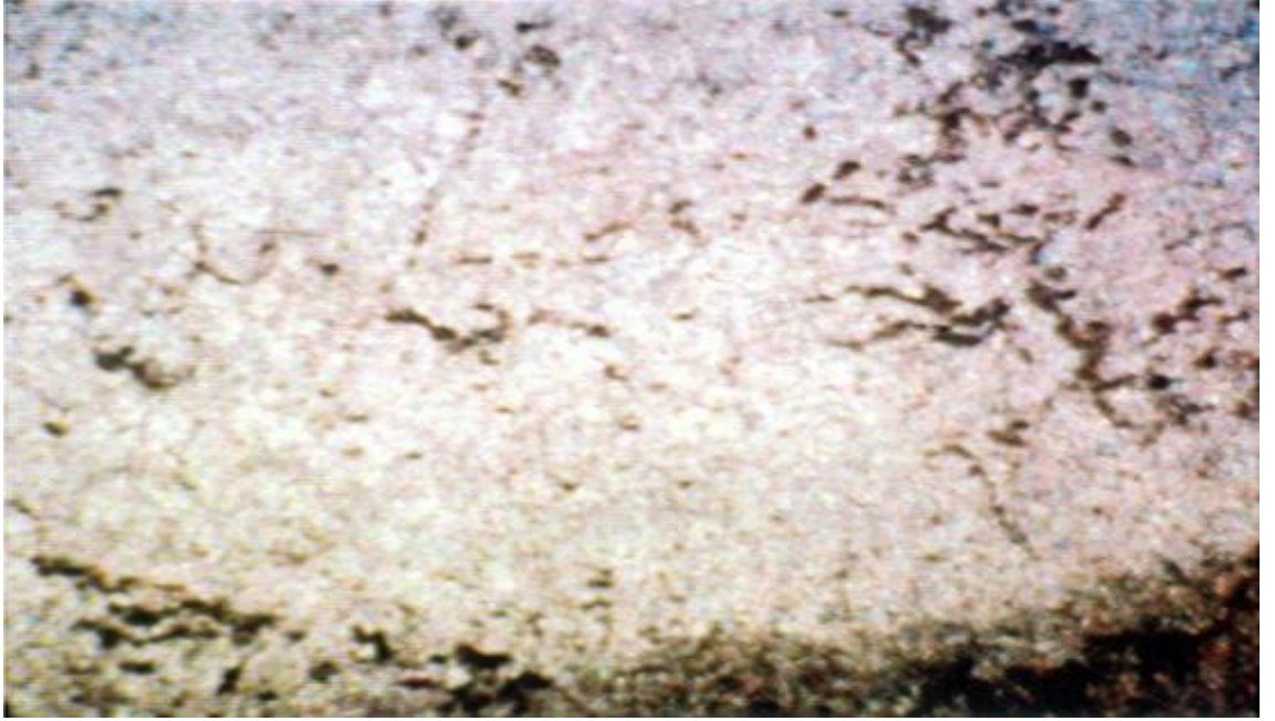
Şekil 5.13 Aplitik doku gösteren ince taneli güncel hidromanyezit (Kocaadalar Burnu, PI, Büyütme: 2.5*12.5)
