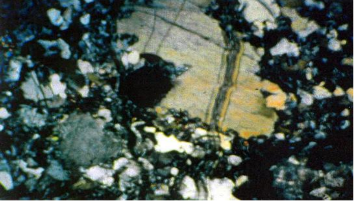
Şekil 5.16 Örneklerimizde farklı oluşum evrelerini gösteren verilere sıkça rastlanmıştır. Gerek tane boyutu açısından gerekse tanelerin içerisindeki çatlak sistemleri boyunca gelişen ikincil oluşumlar yönünden bu örnek son derece önemli bir veridir. Oluşum aşamasındaki kristallenme süresinin hızı ve katılaşma sonrasındaki ikincil oluşumlar için bu örnek çok önemlidir. (PI, Büyütme: 2.5*12.5)
