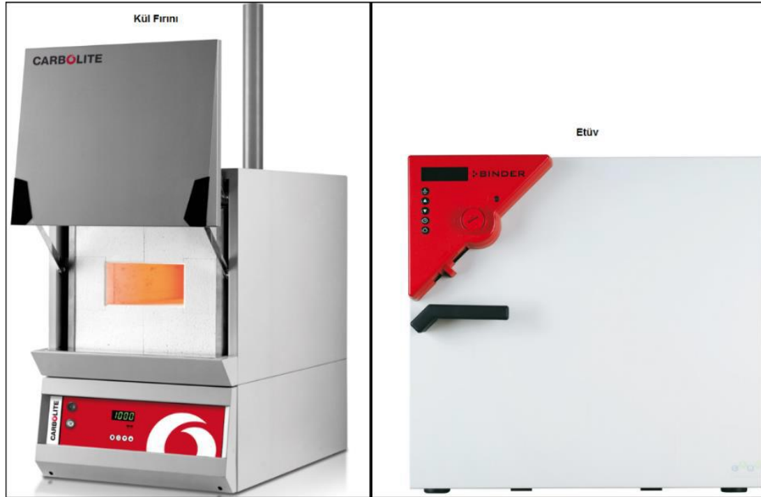
Şekil 3.9: Kısa analizde kullanılan fırın ve etüvün fotoğrafları
