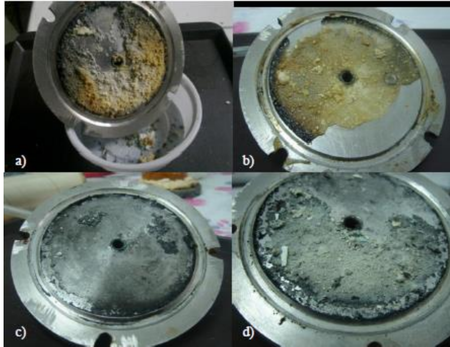
Şekil 3.11 : Düşey sprej piroliz düzeneğiyle farklı fırın sıcaklıklarında alt kapakta toplanan partiküllerin görüntüleri a) 600°C, b) 800°C, c) 1000°C, d) 1200°C.
