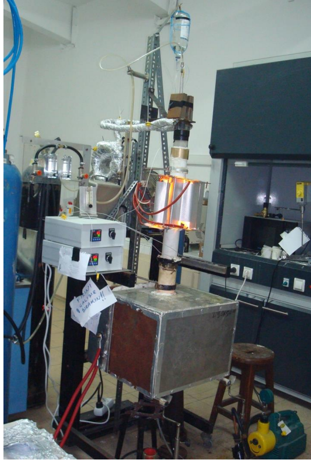
Şekil 3.10 : Revizyon yapılmış düşey deney tesisatı.
