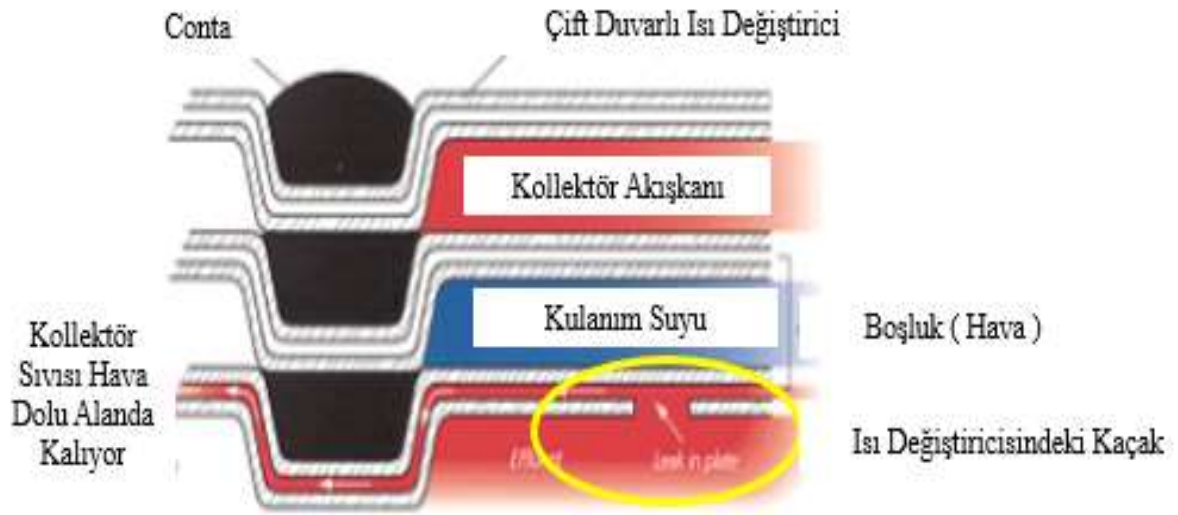
Şekil 1.24 : Duvar Sayısına Göre Isı Değıştirici Tiplerinin Karşılaştırılması [25].
