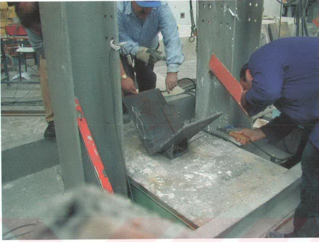
Şekil A.3. Alt başlığın kaynak ile sabitlenmesi
