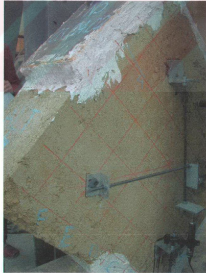
Şekil A.34. Numune 3'ün arka yüzünde 4 tonda oluşan çatlaklar
