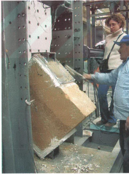
Şekil A.8. Numune1'in üzerine alçılanmış üst başlığın konulması
