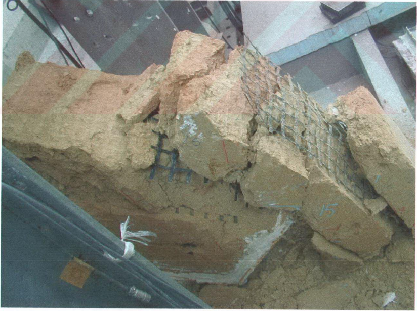
Şekil A.20. Üst başlık alındıktan sonra Numune 1'in katmanlaşması
