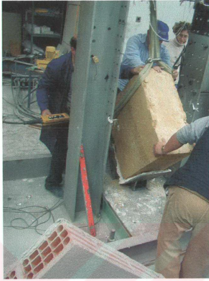
Şekil A.7. Numune1'in deney düzeneğine yerleştirilmesi
