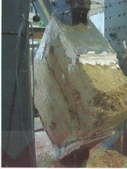
Şekil A.29. Numune 2'nin arka yüzünde 8 tonda oluşan çatlaklar
