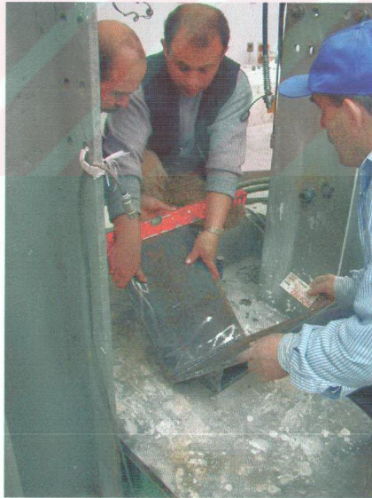
Şekil A.2. Alt başlığın düzeneğe yerleştirilmesi
