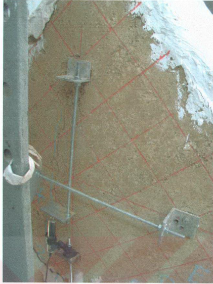
Şekil A.37. Numune 3'ün ön yüzünde 10 tonda oluşan çatlaklar
