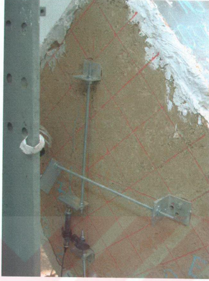
Şekil A.35. Numune 3'ün ön yüzünde 7 tonda oluşan çatlaklar
