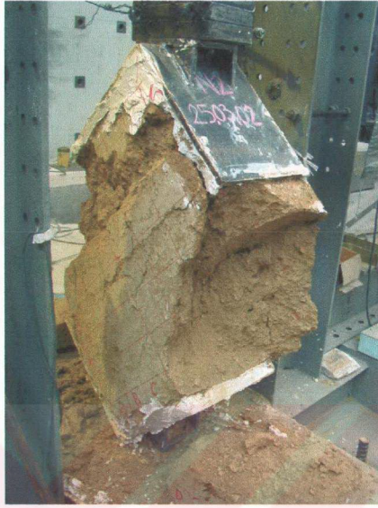
Şekil A.31. Deney sonunda Numune 2'nin ön yüzünün başka bir görünüşü
