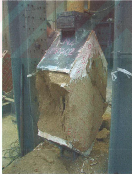
Şekil A.32. Deney sonunda Numune 2'nin arka yüzünün görünüşü
