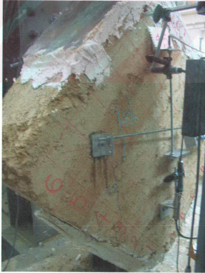
Şekil A.24. Numune 2'nin ön yüzünde 5.5 tonda oluşan çatlaklar
