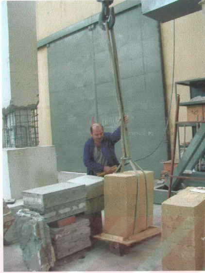
Şekil A.5. Numune1'in vinç yardımı ile kaldırılması
