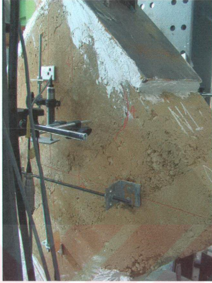
Şekil A.13. Numune 1'in arka yüzünde 4 tonda oluşan çatlaklar
