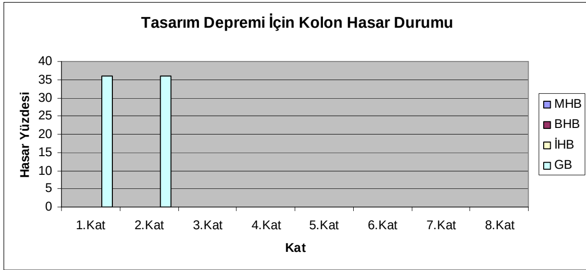
Çizelge C.15 : Zaman Tanım Alanında Hesap Yöntemi İle Tasarım Depremi Etkisi Sonucu Oluşan Kolon Hasar Yüzdesi
