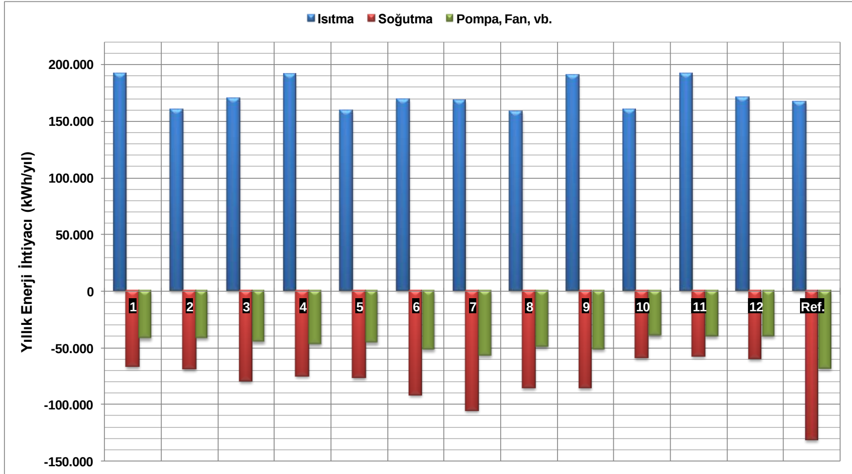
Şekil 4.22 : Cam tipi ve gölgelendirme elemanlarının oluşturduğu alternatiflerin yıllık enerji ihtiyaçlarına etkisi.
