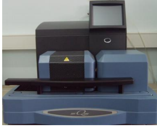
Şekil 4.4 : Termal analiz cihazı.
