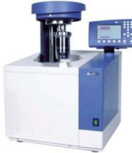
Şekil 4.6 : IKA C2000 model kalorimetre.
