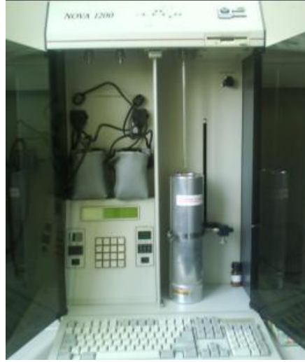
Şekil 4.5 : Yüzey alanı ölçüm cihazı.
