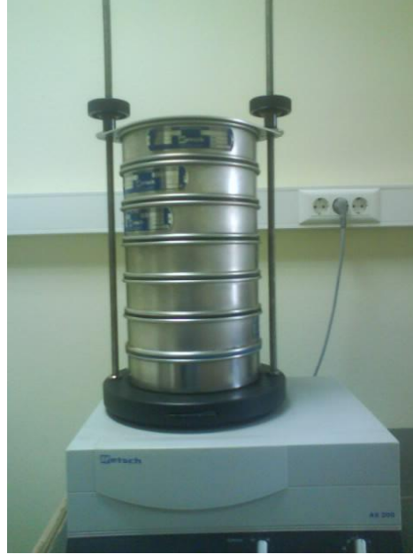
Şekil 4.1 : Retsch AS 200 elek sistemi.
