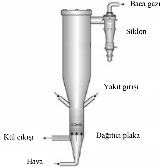
Şekil 3.6: Kabarcıklı akışkan yataklı kazan [47].
