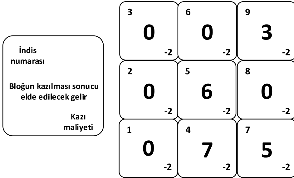
Şekil 2.24: Tamsayı programlama örnek blok modeli.
