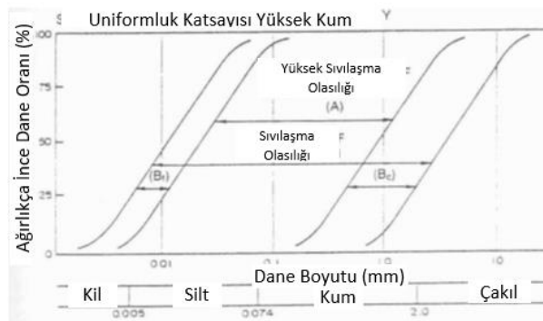
Şekil 3.4 : Yüksek uniformluluk katsayısına ( c_u ) sahip zemin türleri için sıvılaşma potansiyelinin yüksek olduğu granülometri aralıkları [11]
