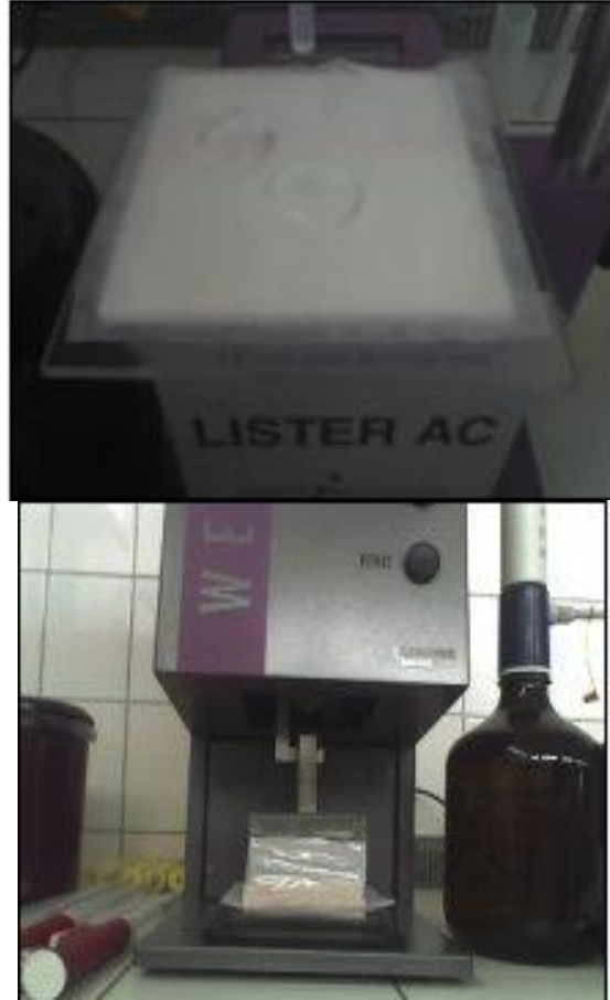
Şekil 6.5 : Sıvı transferi ve yeniden ıslatma testleri için LISTER AC.
