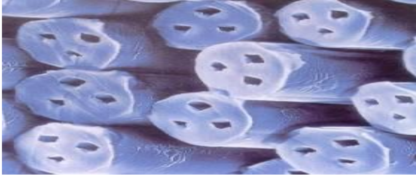
Şekil 2.24 : Beton takviyesinde kullanılan polipropilenin boşluklu yapısı.
