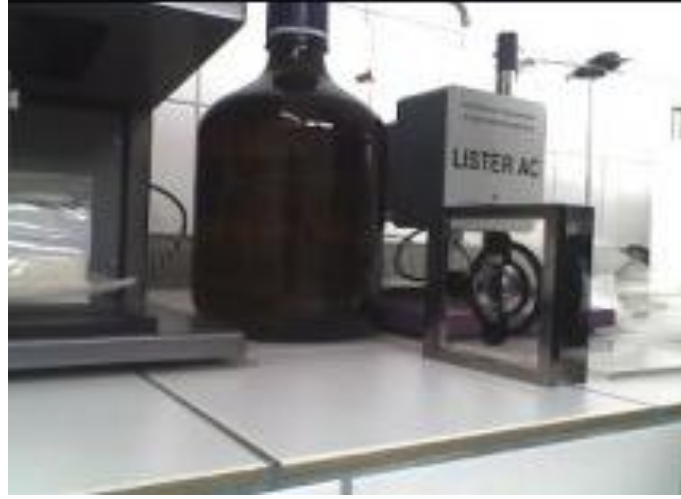
Şekil 6.6 : Sıvı transferi ve yeniden ısılatma testleri için LISTER AC.
