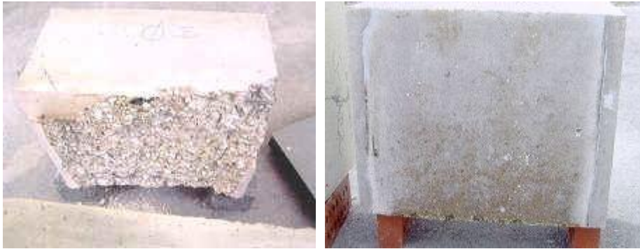
Şekil 2.25 : Lif takviyesiz ve lif takviyeli beton
