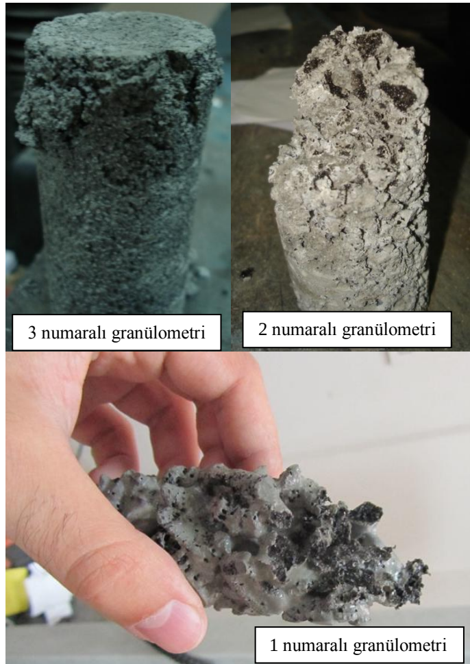
Şekil 4.15 : Numunelerin serbest basınç deneyi sonrasındaki görünümü.
