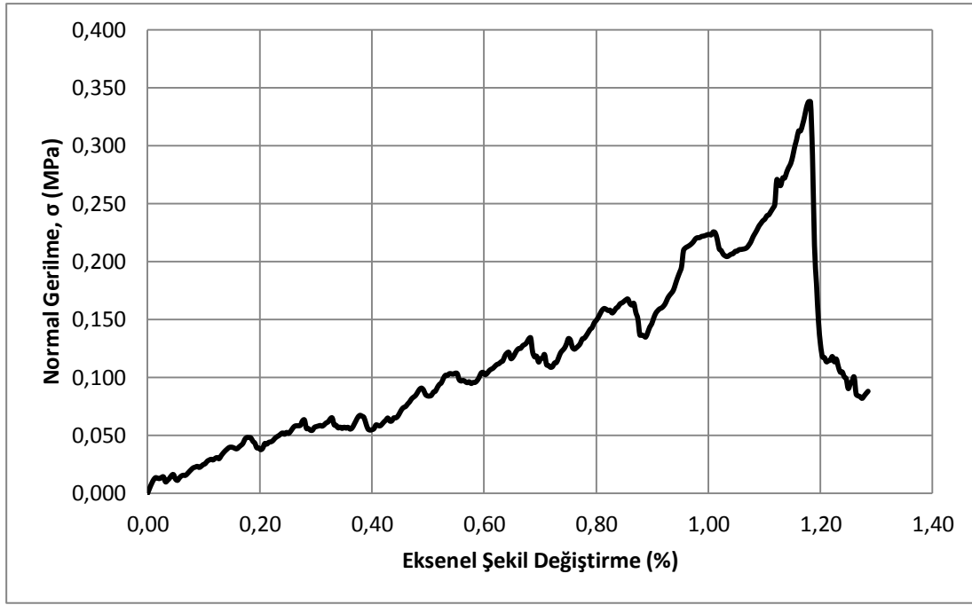
Şekil A.22 : 1-4-3 kodlu numunenin normal gerilme – eksenel şekil değiştirme davranışı
