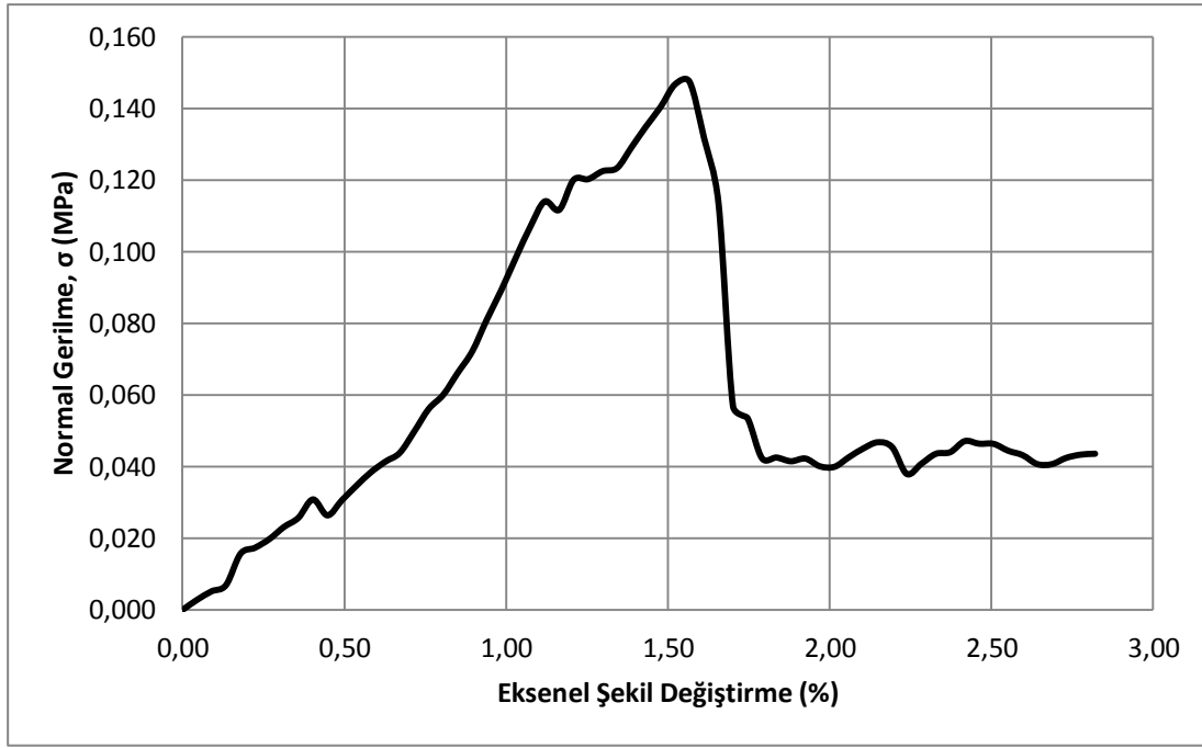
Şekil A.42 : 3-1-2 kodlu numunenin normal gerilme – eksenel şekil değiştirme davranışı
