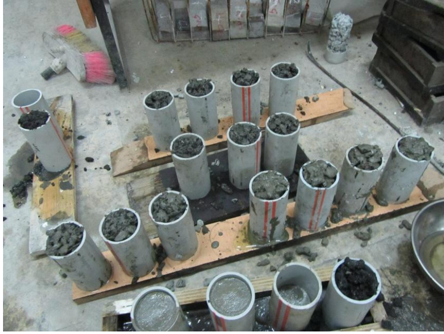
Şekil 4.7 : Numune kalıpları (Çap: 50 mm, Yükseklik: 100 mm).
