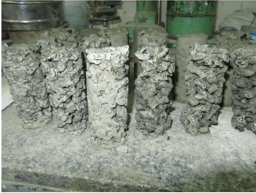
Şekil 4.8 : Kalıp sökümü sonrası numuneler.
