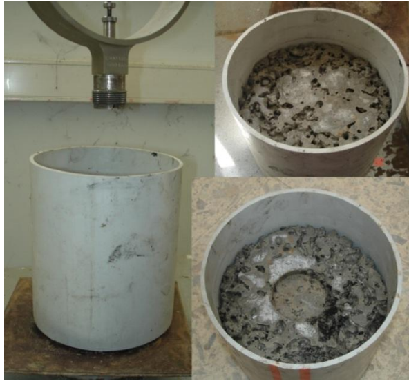
Şekil 4.20 : CBR deneyi, numunenin deney öncesi ve sonrasındaki görünümü.
