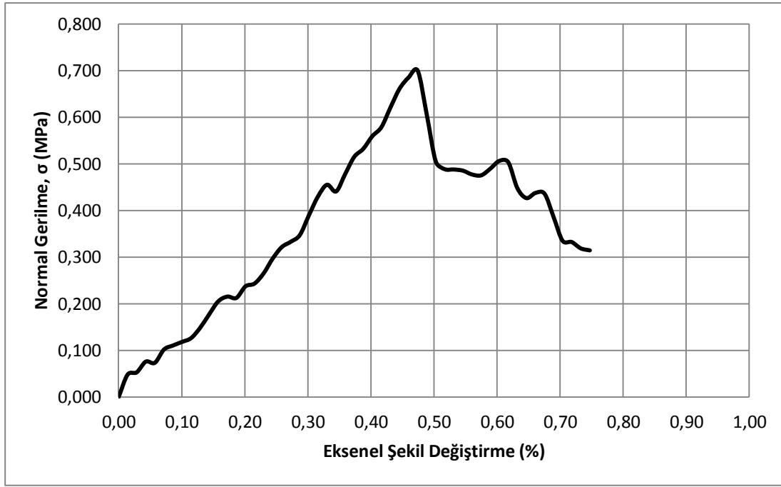
Şekil A.73 : 7-3 kodlu numunenin normal gerilme – eksenel şekil değiştirme davranışı
