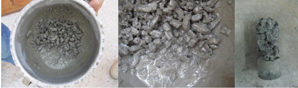
Şekil 5.3 : Kum oranı artışı ile beraber meydana gelen ayrışma problemi
