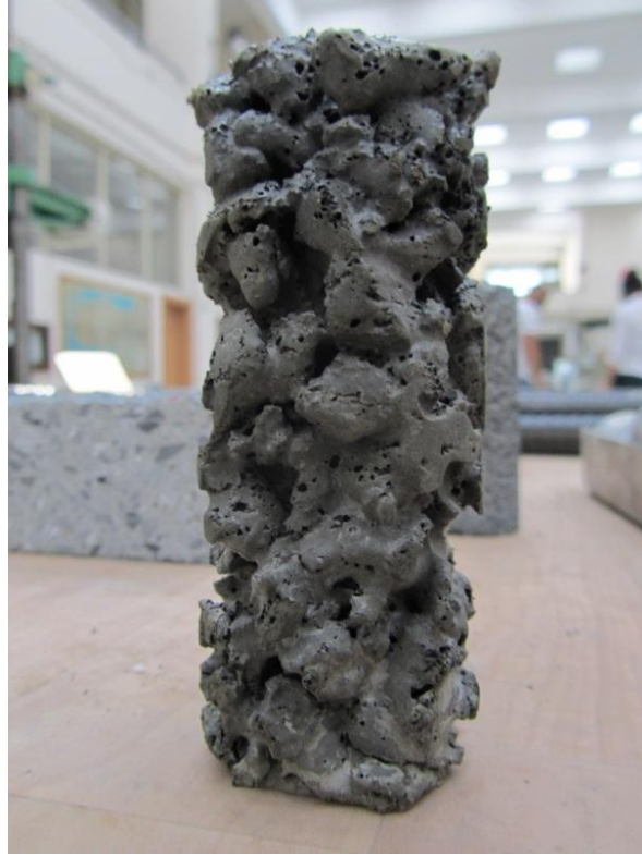
Şekil 4.17 : Serbest basınç deneyinden önce numunenin görünümü (7-1).
