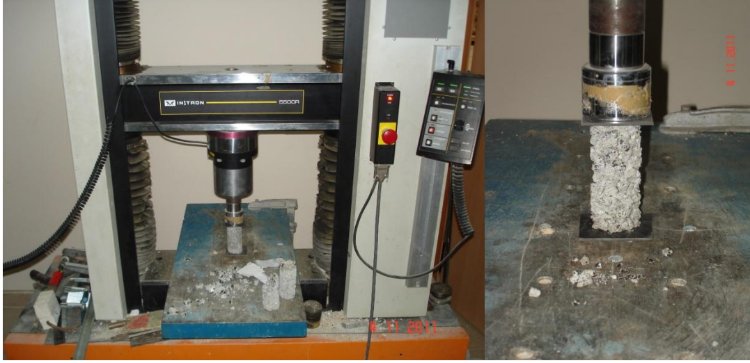
Şekil 4.11 : Serbest basınç deney düzeneği
