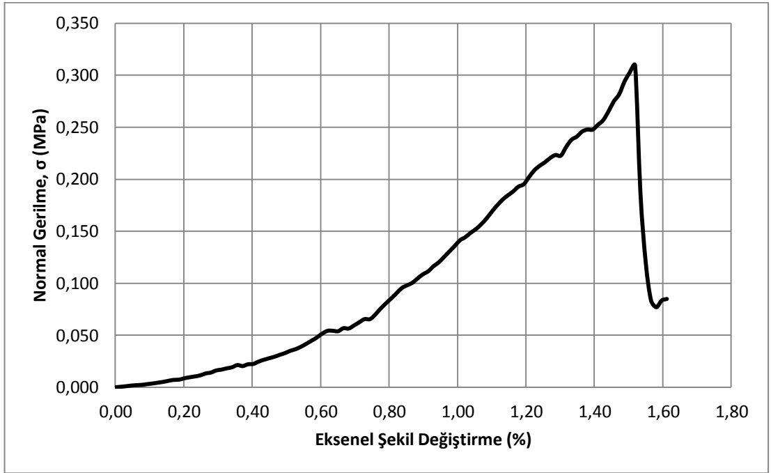
Şekil A.45 : 3-2-2 kodlu numunenin normal gerilme – eksenel şekil değiştirme davranışı
