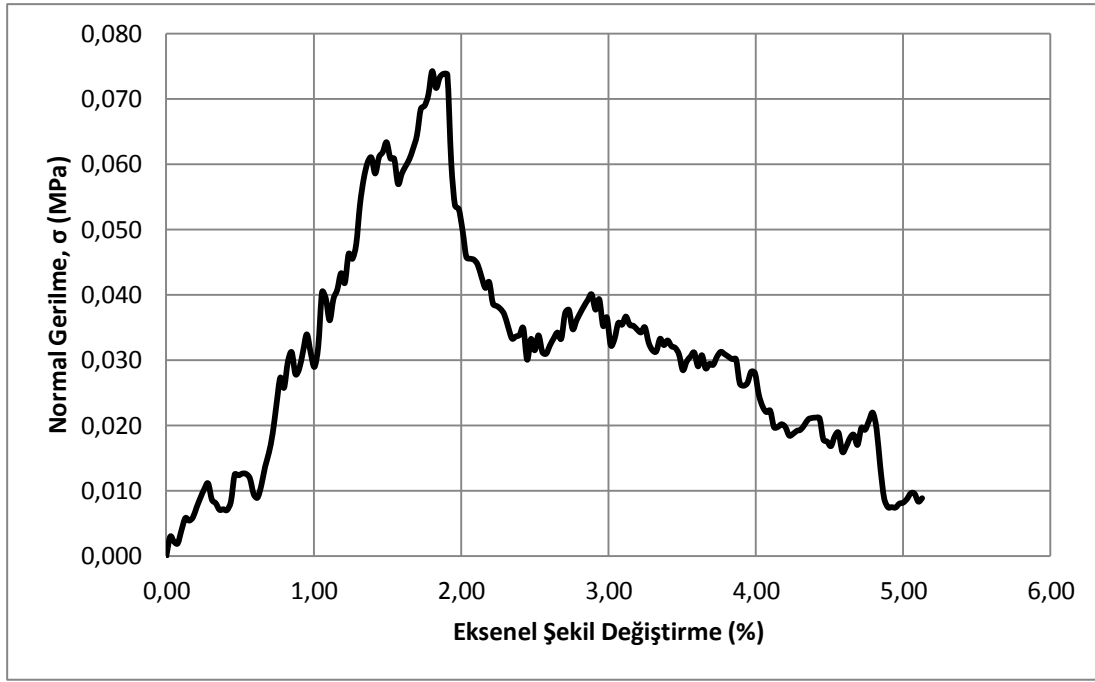
Şekil A.18 : 1-3-2 kodlu numunenin normal gerilme – eksenel şekil değiştirme davranışı
