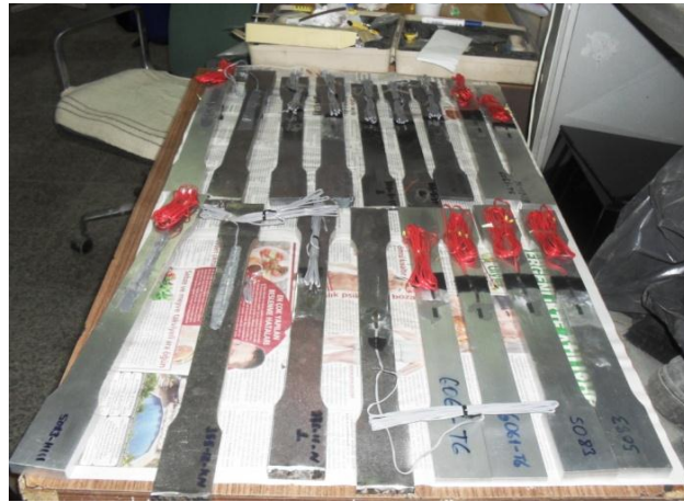
Şekil 2.7 : Strain-gauge yapıştırılan 19 adet çekme numunesi.
