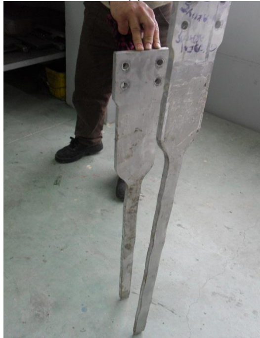
Şekil 6.18: (a) BRB-AC2 numunesi analiz sonucunda von Mises akma gerilmesi dağılımı. (b) Deney sonrası yapılan kesit açılımında BRB-AC1 numunesinde gözlenen burkulma dalgaları.
