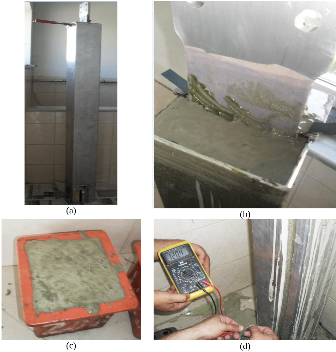
Şekil 3.14 : (a) BÖÇ'ler için tasarlanan merkezlendirme sehpası. (b) Dolgu malzemesi ile doldurulması. (c) Dolgu malzemesinden basınç dayanımının belirlenmesi için numune alınması. (d) Metal içindeki strain-gauge akım kontrolünün yapılması.
