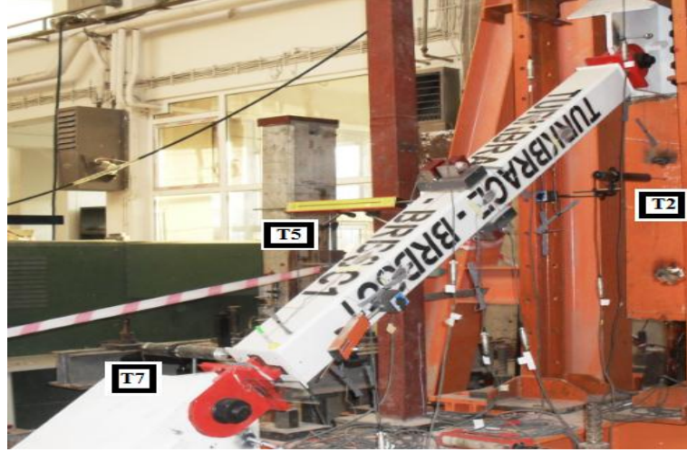
Şekil 3.27 : Çaprazın düzlem dışı hareketini kontrol eden T5 ve T7 yerdeğiştirme ölçerlerin yerleşimi.
