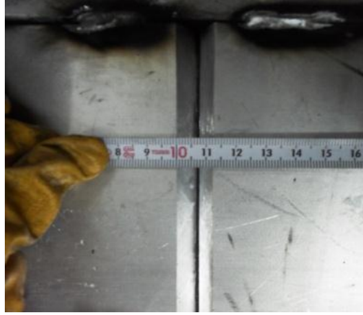
Şekil 2.17 : Kaynak ağız genişliğinin en üst yüzeyden ölçülmesi.
