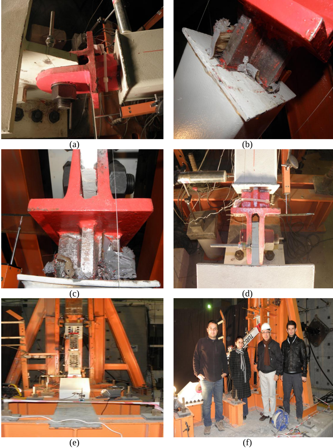
Şekil A:6 : (a) Alt uç birleşim bulonlu birleşim durumu. (b) Üst uç kaynaklı birleşim durumu. (c) Üst uçta oluşan teflon hasarı. (d) Alt uç düzlem dışı durum. (e) Numunenin deney sonrası düzlem dışı durumu. (f) Deney ekibi (sol baştan): Araş.Gör. Cem Demir, Araş. Gör. Çiğdem Karataş, Prof.Dr.Oğuz Cem Çelik, İnş. Müh. Seçkin Çetinkaya.
