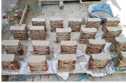
Şekil 3.22 : Minare üretimi için kullanılan tuğla birimleri.
