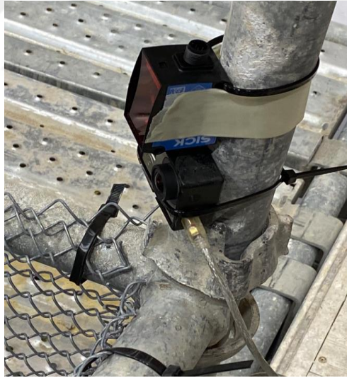
Şekil 3.11 : Lazer deplasman sensörü ve kamera.
