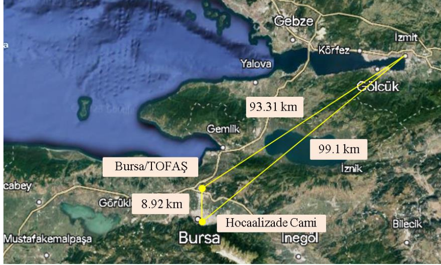
Şekil 3.17 : Bursa/Tofaş istasyonunun minare ve deprem merkez üssüne uzaklığı.
