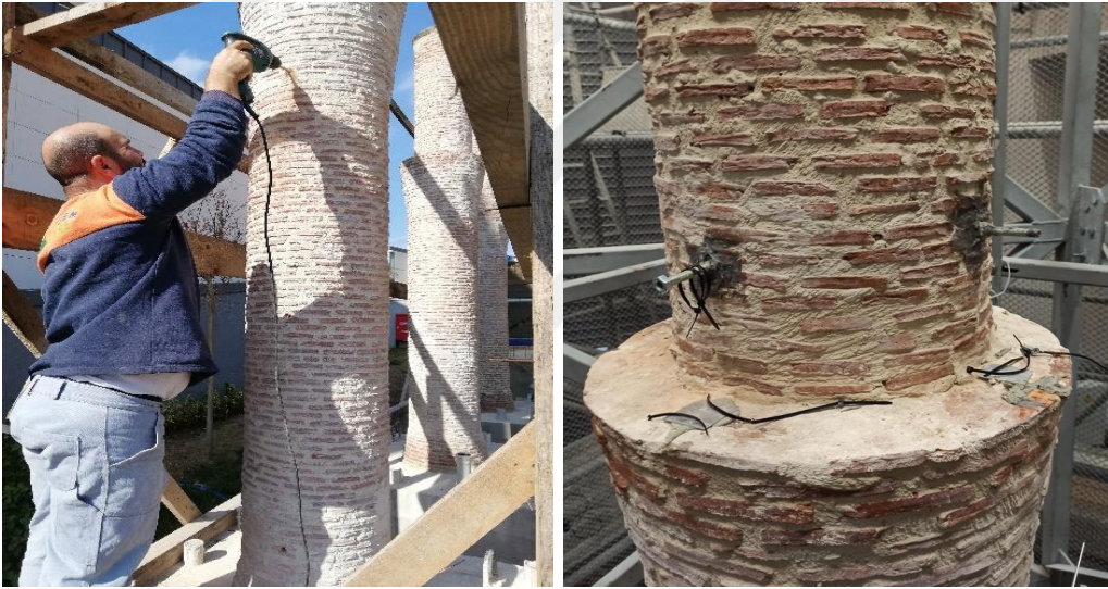
Şekil 3.30 : Ölçüm cihazlarının sabitlenmesi için tij yerleşimi.
