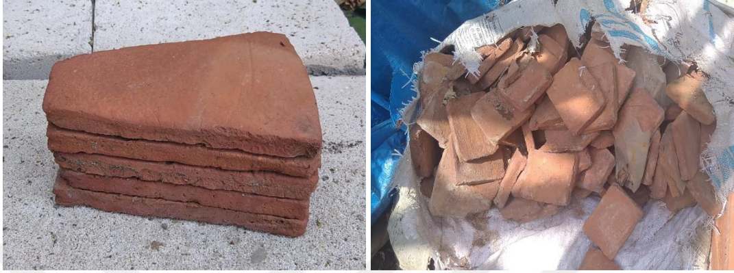
Şekil 3.20 : Minare üretimi için kullanılan tuğla birimleri.
