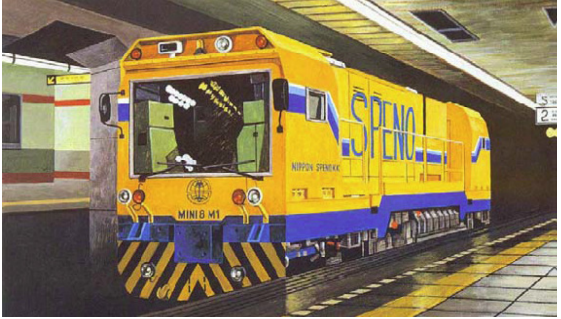
Şekil 2.4: Speno International ray taşlama makinesi.
