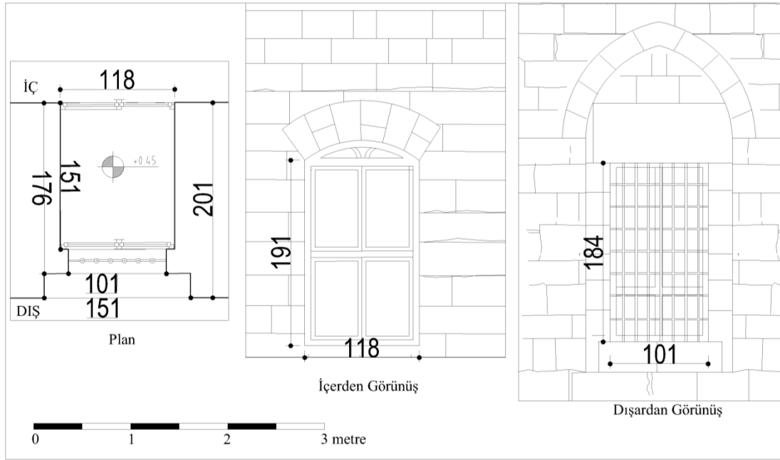
Şekil 3.30 : Ulu Cami harimindeki kible pencerelerinden birinin planı, iç - dış görüşleri ve ölçüleri (cm).
