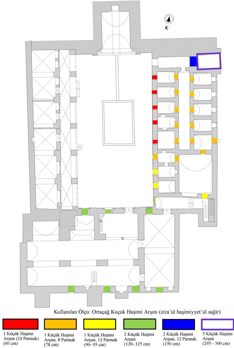
Şekil 3.34 : Şehidiye Medresesi kapı ve pencerelerindeki ölçü değerleri.
