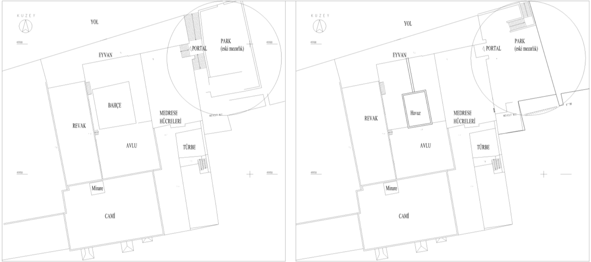
Şekil 2.61 : Solda medresenin 2004 yılında kurulca onaylanan vaziyet planı rölövesi, sağda vaziyet planının restorasyon projesindeki önerilen durumu. Çember içindeki alanın düzenlenmesi restorasyon projesindeki gibi uygulanmamış, rölövedeki gibi kalmıştır (DVBMA).
