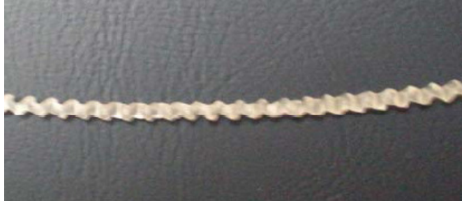
Şekil 4.3 : Yüzey bozulması(melt fracture)
