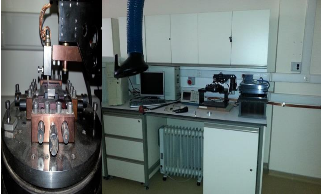
Şekil 3. 4 : Otomatik çalışan ESD cihazı (solda) ve donanımı [8].
