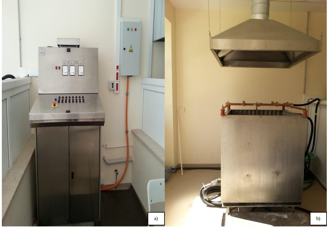
Şekil 3. 9 : Mikro ark oksidasyon cihazı kontrol paneli (a) ve cihaz (b) [8].
