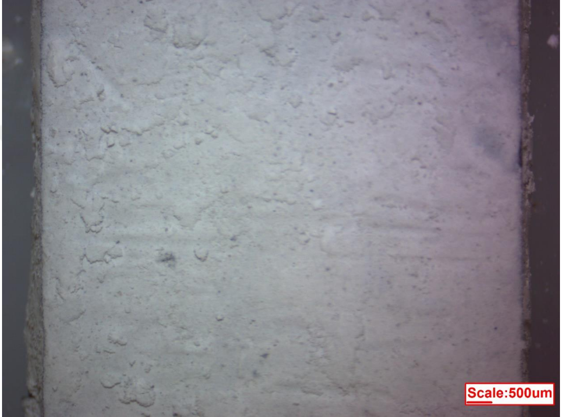
Şekil 7.17: AZ91 Mg alaşımının elektrostatik spreyle yöntemiyle hidroksiapatit kaplanması sonrası Stereo mikroskop görüntüsü.
