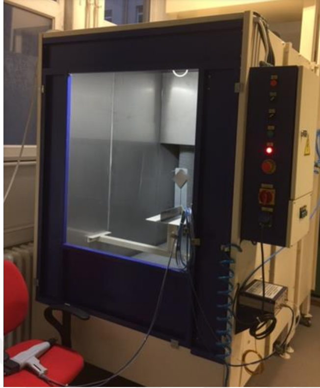
Şekil 6.6: Elektrostatik kaplama kabini.
