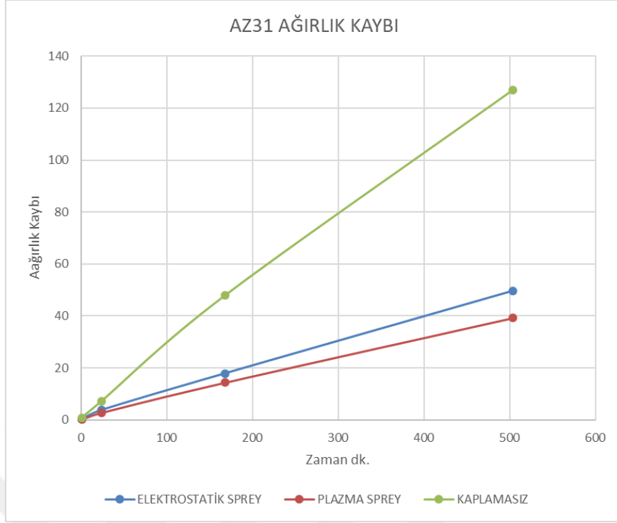
Şekil 7.32: Kaplama yöntemlerinin AZ31 alaşımı için ağırlık kaybına etkisi.
