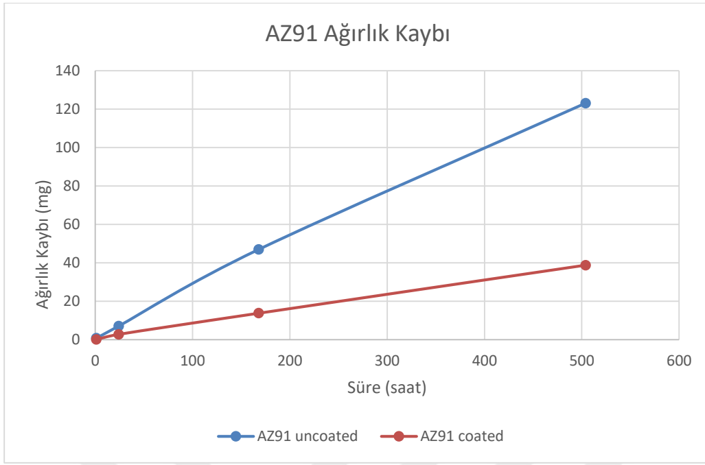
Şekil 7.25: AZ91 için atmosferik plazma spreyle kaplamanın ağırlık kaybına olan etkisi.
