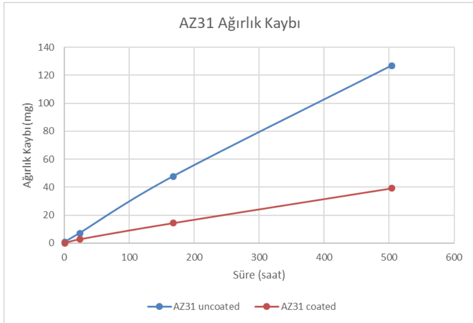
Şekil 7.24: AZ31 için atmosferik plazma spreyle kaplamanın ağırlık kaybına olan etkisi.
