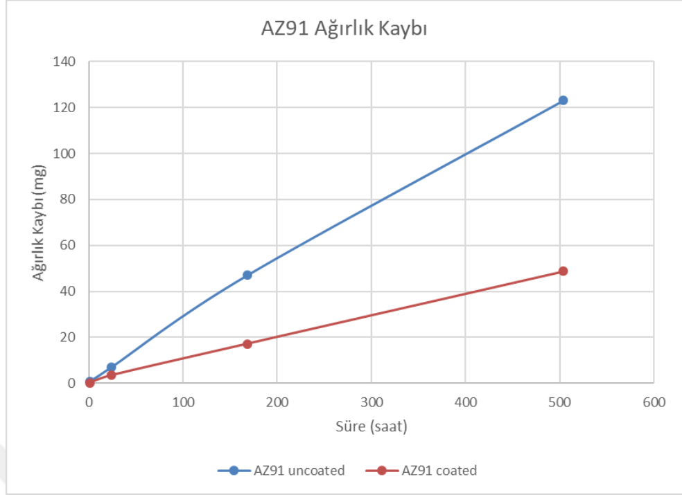
Şekil 7.29: AZ91 için elektrostatik spreyle kaplamanın ağırlık kaybına olan etkisi.
