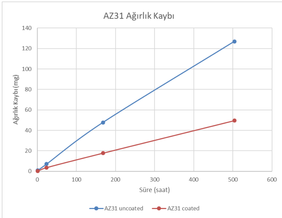
Şekil 7.28: AZ31 için elektrostatik spreyle kaplamanın ağırlık kaybına olan etkisi.
