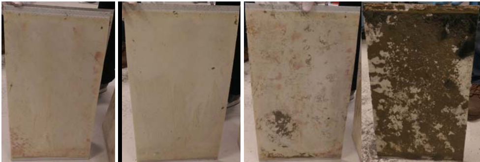
Şekil 4.77 : MBR-4 modül levha görüntüleri-3.
