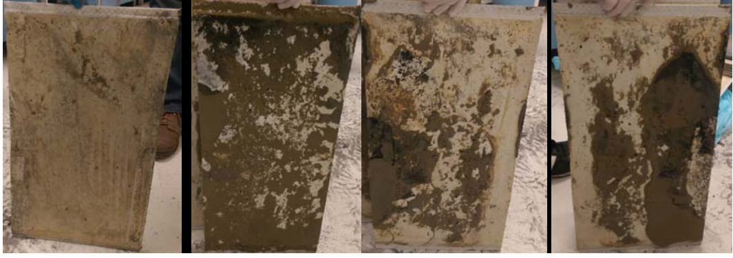
Şekil 4.78 : MBR-4 modül levha görüntüleri-4.
