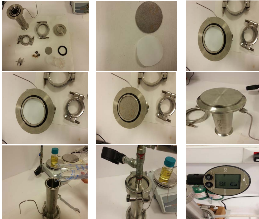
Şekil 3.26 : Filtrasyon deney düzeneğinin hazırlanma aşamaları.
