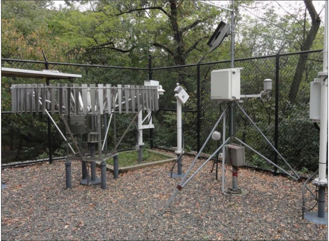
Şekil 2.26: Sabit meteoroloji istasyonlarına veya mobil traverslere monte edilen in situ sensörler (Mccartney & Mehta, 2020).
